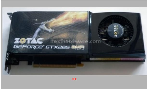
Come di consueto Zotac ha deciso di seguire il reference design di NVIDIA non apportando modifiche al PCB o al dissipatore. La GPU è prodotta 55 nm riducendo i consumi e permettendo di inalzare le frequenze operative. La scelta di utilizzare una GPU a 55 nm è dettata dai minori costi e dalla migliore resa produttiva, questo non influisce sul prezzo di acquisto della scheda, che rispecchia quello delle GTX 280 che la nuova nata di casa NVIDIA andrà a sostituire.
