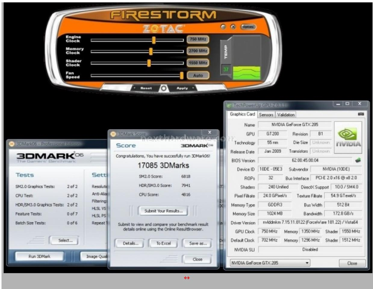
Ragguardevole è la velocità raggiunta dalle memorie ben 2700 Mhz e quella degli shader 1550 Mhz. La GPU si è fermata a 750 Mhz, poco meno della Zotac GeForce GTX 280 AMP! Edition che avevamo potuto testare in precedenza lo scorso giugno.
