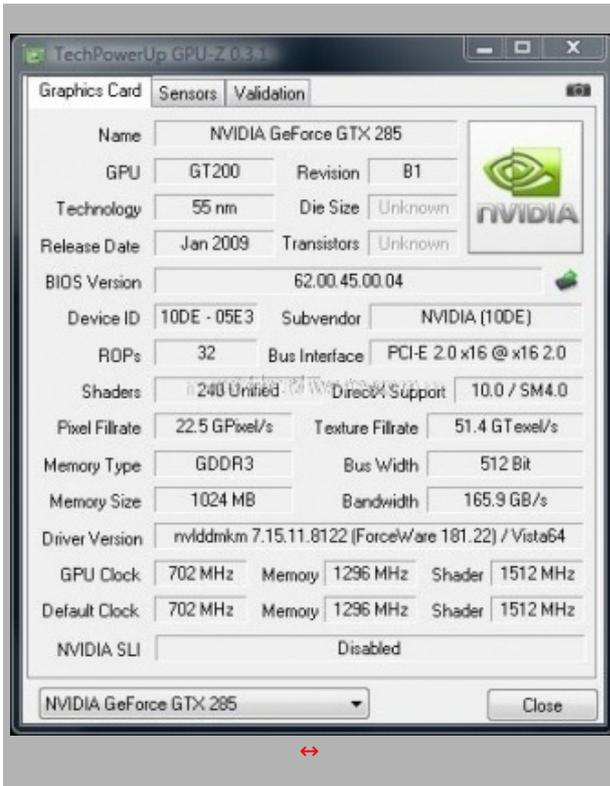
La GPU utilizzata dalla Zotac GTX 285 AMP! Edition è l'ultima revisione della GT200 di NVIDIA, costruita con il processo produttivo a 55 nm.
