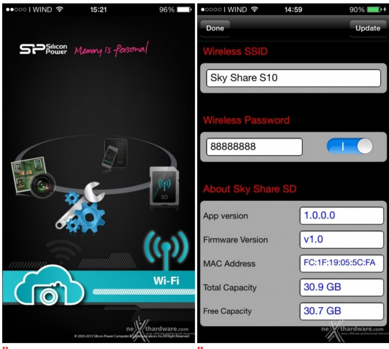
Nel menu impostazioni potremo editare il SSID del dispositivo, la password con cifratura WPA2 e visualizzare alcune informazioni come la versione dell'app, quella del firmware, il MAC Address dell'adattatore e la capacità della microSD.
