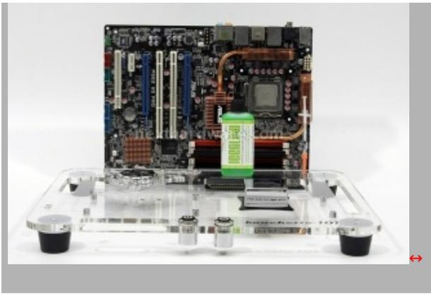
La scheda madre che sarà la "base" del sistema è una **ASUS P5E3 WS PRO** , la **CPU** un **Intel E8500** e le memorie delle **Cellshock DDR3 1800** .
