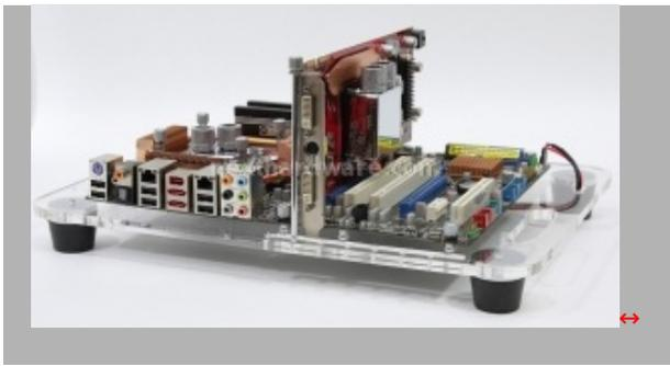
Posizioniamo quindi i waterblock su CPU e VGA. Vi preghiamo di prestare attenzione al sistema di fissaggio delle schede di espansione. Un praticissimo asse in acciaio inox che blocca la scheda per mezzo di una vite M3.
