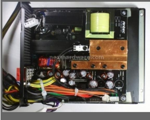
Da queste due foto si riesce facilmente a capire la logica di funzionamento del sistema di dissipazione. Visto l'impiego di tutto lo spazio disponibile era impossibile posizionare una ventola di dimensioni maggiori agli 80mm. Questo perché l'unico spazio rimasto libero, era quello sui due lati con la superficie minore.
