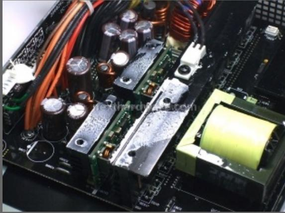
Rimossa la placca in rame utilizzata per diffondere su una superficie piu' grande il calore generato. Notiamo che anche in questo alimentatore sono presenti due piccoli trasformatori DC-DC. Ritroviamo quindi anche in questo prodotto lo schema vincente che abbiamo descritto piu' volte nelle nostre ultime recensioni. Un unico grande rail +12,0 volt, che alimenta a sua volta due piccoli circuiti adibiti ad erogare +3,3 e +5,0volt.
