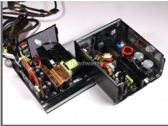
Come potete vedere il Signature è completamente costruito su due Mainboard distinte. La prima che chiameremo "A" si occupa del filtraggio e prima fase della trasformazione, la seconda ("B") gestisce protezioni, ventole e la seconda fase di trasformazione.
