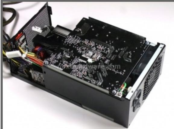
Rimosse anche le viti di fissaggio della prima scheda, e dopo aver scollegato alcuni connettori siamo in grado di separare le due parti del circuito. Svitiamo altre due viti ai fianchi e l'intera struttura scivola dividendo di fatto l'alimentatore in due parti distinte.
