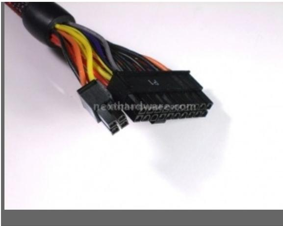
Cavo di alimentazione ATX 24pin
