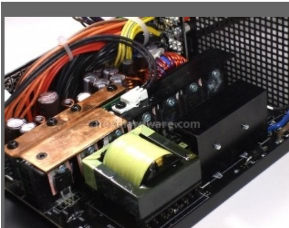
In questa immagine si vedono molto bene tutti gli integrati utilizzati per la trasformazione +12,0 volt. Notiamo inoltre il trasformatore in posizione orizzontale per contenere gli ingombri.
