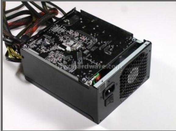
Svitate le prime due viti e rimossa la parte superiore del cabinet, notiamo subito qualcosa di strano in questo alimentatore. Sembra che ci siano due alimentatori nello spazio necessario a contenerne uno. E' la prima volta che ci capita di analizzare un prodotto costruito con questa logica e non nascondiamo l'entusiasmo nel verificare che finalmente qualcuno propone soluzioni realmente innovative.
