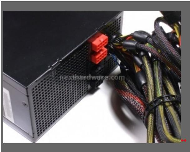
Pannello connessioni modulari, notate la grande massa di cavi saldati, sufficienti per alimentare la maggior parte dei computer in circolazione. Peccato che Antec abbia scelto di non rivestire i cavi fino all'interno del alimentatore, probabilmente perché non sarebbe stato possibile contenere l'intera massa di cavi considerando il particolare tipo di sleaving utilizzato.
