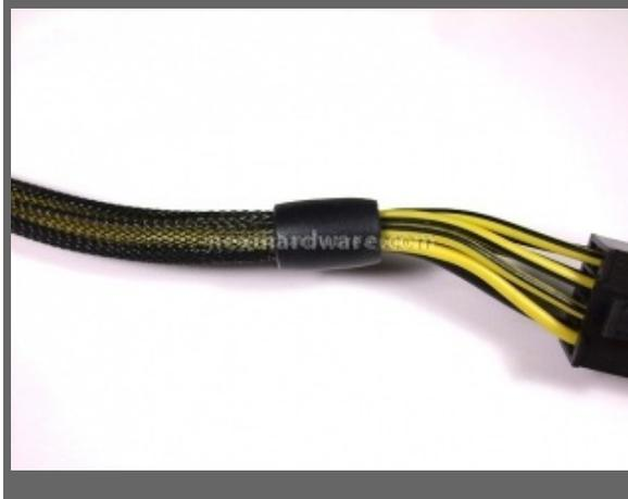
Dopo le interessanti novità nella sezione interna, notiamo con piacere che Antec ha sviluppato un nuovo sistema di ritenzione per la maglia di rivestimento dei cavi. Questo sistema aumenta leggermente la massa del cavo, ma allo stesso tempo evita che la guaina in PVC si possa muovere.
