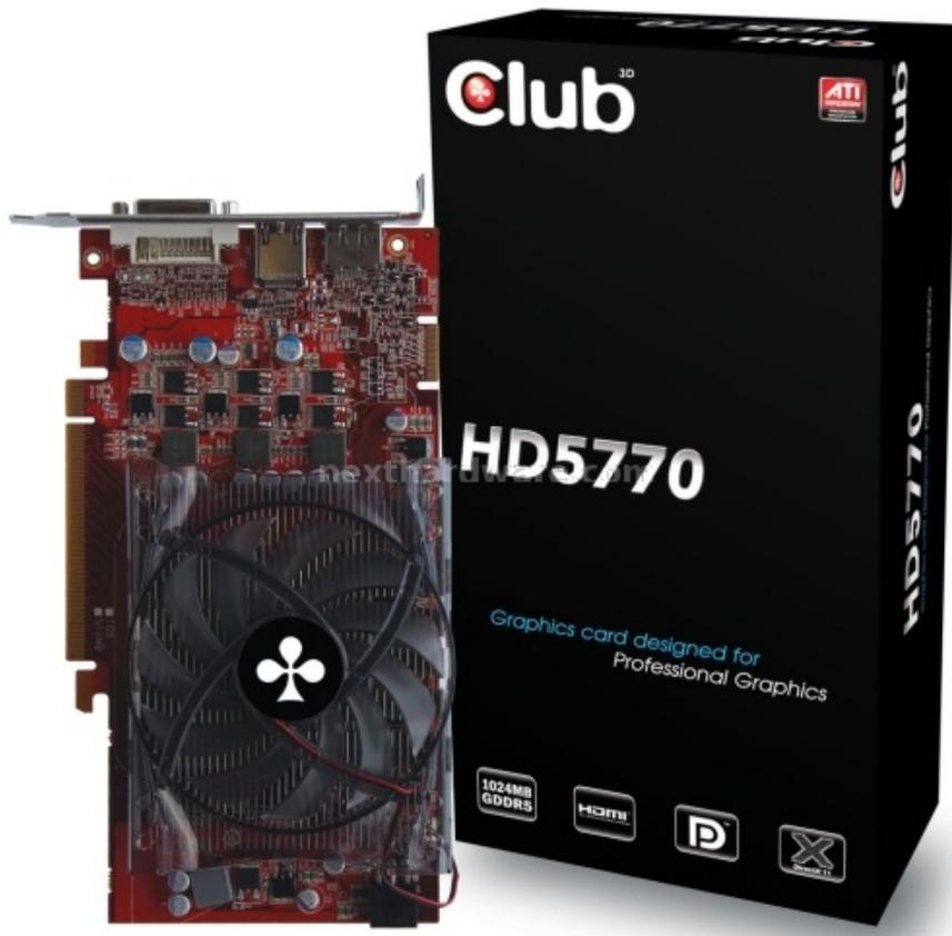
Seguendo le orme di Sapphire e Powercolor, Club3D ha deciso di lanciare una scheda Radeon HD 5770 non reference, dotata di dispositivo di raffreddamento Arctic Cooling. La HD 5770 di Club3D ha frequenze di funzionamento di 850MHz per la GPU e 4800MHz le memorie GDDR5. Il sistema di raffreddamento occupa un solo slot, e ciò comporta che le uscite DVI, HDMI e DisplayPort siano uniche.
