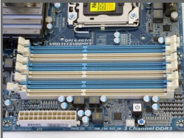
La scheda è dotata di 6 slot che consentono l'utilizzo contemporaneo di 6 moduli di memoria per un totale di 24 GB di RAM. Le DIMM da utilizzare sono di tipo DDR3, la scheda supporta moduli con frequenze pari a 800/1066/1333/1867/2100+ Mhz.
