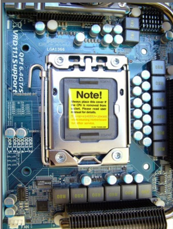
La zona attorno al socket è abbastanza sgombra e grazie allo spazio a disposizione consente di adottare delle soluzioni di raffreddamento piuttosto voluminose. Si vedono le 14 induttanze relative alle fasi di alimentazione che sono 12+2 per l'implementazione della specifica VRD 11.1, che consente il funzionamento della scheda con sole due fasi di alimentazione.
