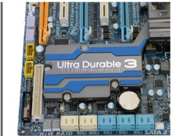
Il raffreddamento del southbridge è affidato ad un dissipatore di alluminio collegato a quello del northbridge attraverso delle pipe in rame.
