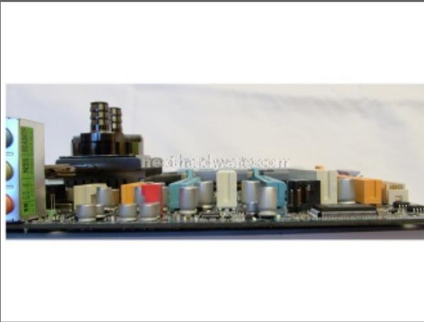
Da questa foto è possibile notare la distanza tra i vari slot di espansione nella quale si vede chiaramente che la maggior parte degli slot è utilizzabile anche con schede pci express dual slot. Unico problema è che le eventuali schede dual slot installate vanno a coprire gli slot di espansione PCI. Rimangono utilizzabili gli slot pci express 1x e 4x.
