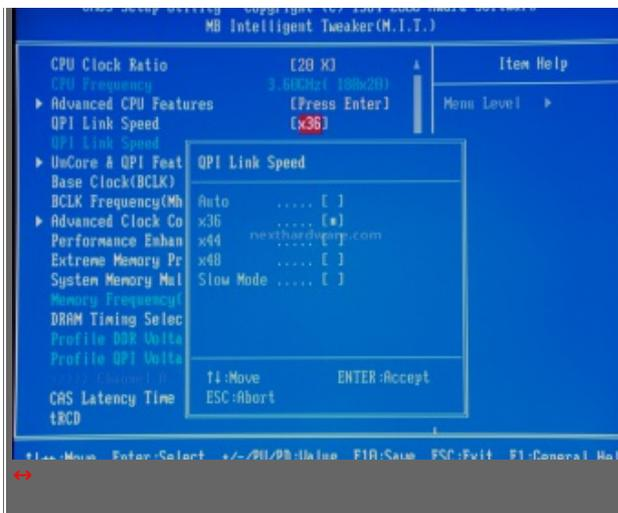
Accedendo al settaggio QPI Link Speed si vede come i moltiplicatori disponibili sono x36, x44 e x48; in auto il moltiplicatore si imposta a x36, inoltre esiste un'ulteriore impostazione che consente di settare il moltiplicatore ad una velocità detta Slow e pari a 100 MHz (ignoriamo quello che sia l'unità di questa ulteriore impostazione Slow).
