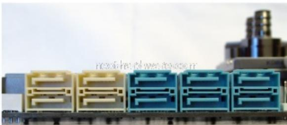
La scheda madre ha una dotazione notevole di connessioni Serial ATA pari a 10, su sei delle quali è possibile configurare volumi raid tramite il controller Intel ICH10R.
