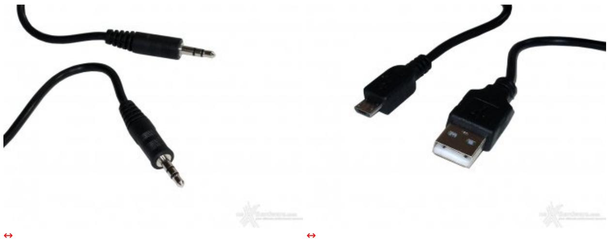
Entrambi i cavi inclusi in bundle risultano essere robusti e solidi; l'utilizzo del cavo con jack da 3,5mm è prettamente dedicato all'uso con dispositivi non dotati di connessione Bluetooth.
