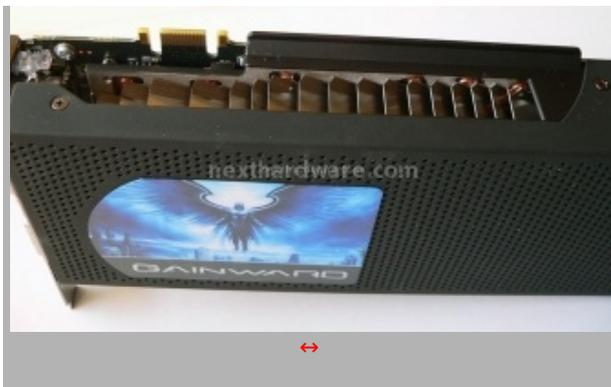
Il dissipatore è dotato di un numero elevato di heatpipe, necessarie per distribuire in modo uniforme il calore sulla poca superficie dissipante a disposizione. La struttura è speculare e la differenza di temperatura tra le due GPU raramente supera i due/tre gradi. L'aria calda viene espulsa dalla staffa PCI e dalle alette angolate sul lato superiore della scheda. E' consigliabile curare la ventilazione del case dove verrà utilizzata la GTX 295 al fine di ottenere un raffreddamento ottimale.
