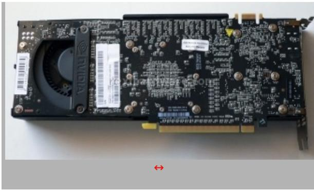
A differenza della 9800GX2 e della GTX280, il retro della scheda non è protetto da una placca metallica, il secondo PCB è quindi a vista. I moduli di memoria e gli altri componenti principali sono tutti saldati all'interno, non sono quindi esposti componenti di particolare rilevanza. Per rendere l'assemblaggio più solido è presente una contro staffa per fissare il dissipatore. La ventola radiale è a vista su entrambi i lati del prodotto.
