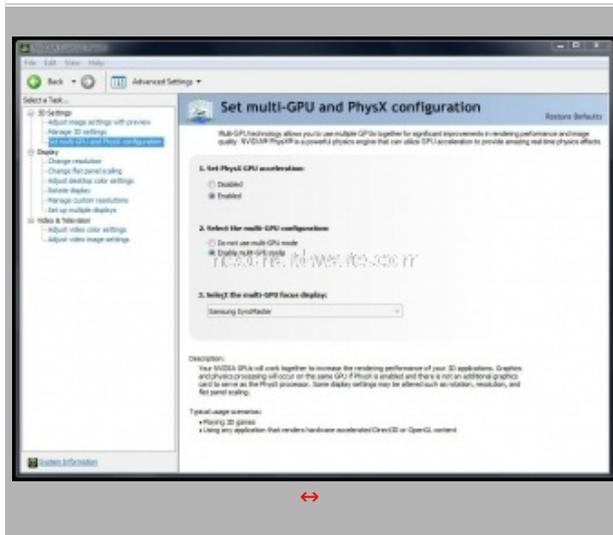
Dal pannello controllo NVIDIA è possibile abilitare e disabilitare PhysX e selezionare quale GPU dovrà occuparsi della simulazione fisica, nel caso la macchina sia dotata di più di una scheda video.
