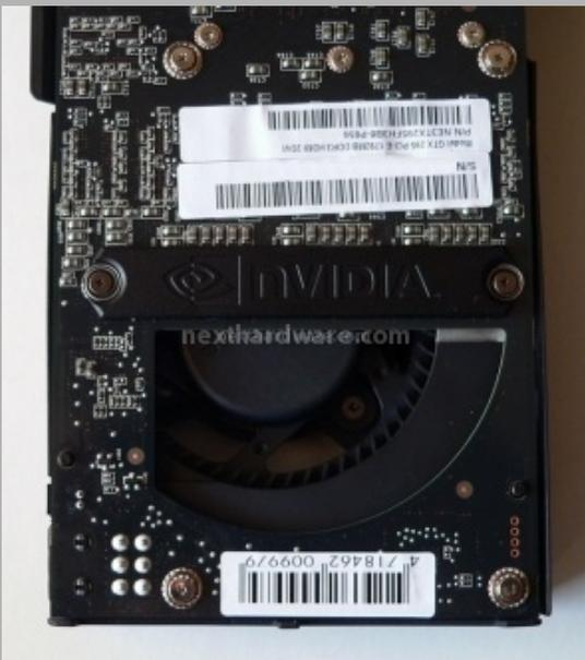
A differenza della 9800 GX2, la ventola non è protetta dalla cover della scheda video ma è visibile all'esterno al fine di non ostacolare il flusso d'aria. La ventola è abbastanza silenziosa, durante il funzionamento con applicativi 3D, abbiamo però notato un certo ticchettio, forse causato da un profilo di regolazione non ancora ottimale o di un difetto del nostro sample.
