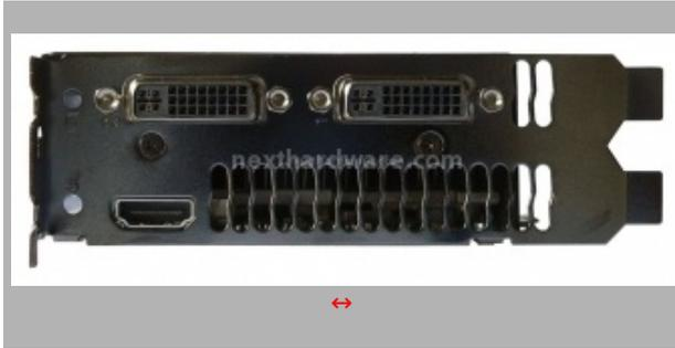
La scheda è dotata di due connessioni DVI Dual Link, con supporto fino a 2560x1536 pixel di risoluzione, in aggiunta è disponibile un connettore HDMI con supporto Audio multicanale. Un led verde indica la corretta alimentazione della GTX 295, il secondo led, di colore blu, indica quale scheda può pilotare i monitor in una configurazione Quad SLI.
