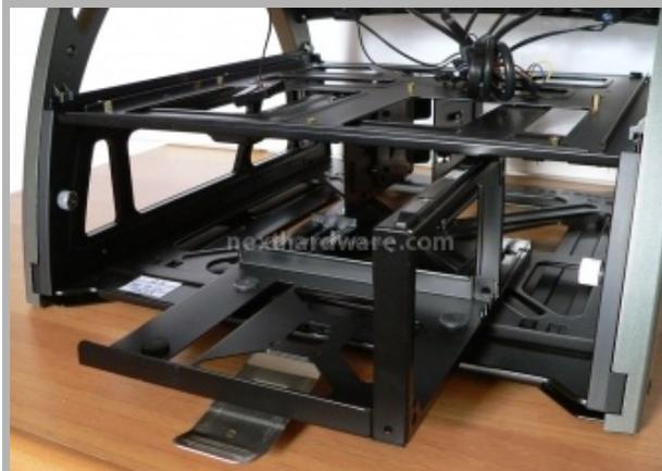
L'alimentatore è alloggiato in un carrello completamente estraibile. A differenza della maggior parte dei case e bench table, il connettore di alimentazione non è sul retro della struttura ma è laterale, questo rende un po' difficile scollegare il cavo dallo stesso: è necessario aprire la paratia di destra per poter procedere in modo agevole.
