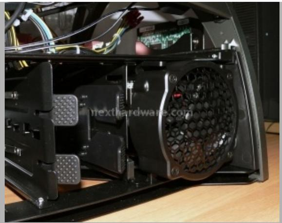
Antec fornisce in bundle con il case anche una ventola 92x92 con connettore 4 pin molex passante. La ventola è già assemblata all'interno del suo cestello, facilmente installabile e rimovibile dallo Skeleton agendo sulle due linguette poste nella parte superiore. Caratteristiche tecniche: Flusso d'aria: 15,6 CFM Emissioni acustiche: 12,7 dBA
