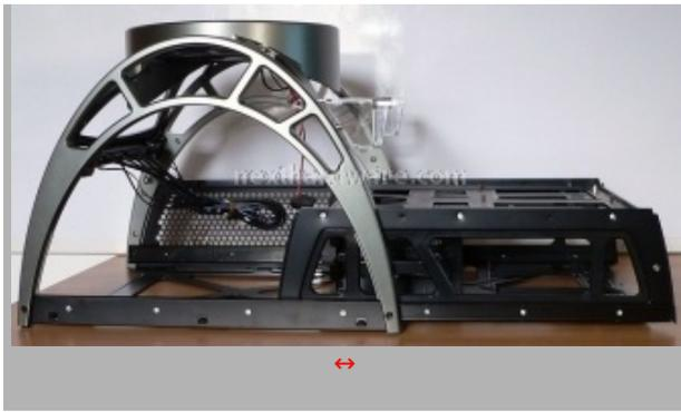
Il cassetto componenti è fissato con due viti a molla svitabili a mano. Questa soluzione è molto confortevole, infatti la vite non viene rimossa dalla struttura e non si corre il rischio di perderla durante i lavori di installazione o manutenzione. Il supporto è rimovibile per facilitare l'installazione e il collegamento dei cavi di alimentazione e dati.
