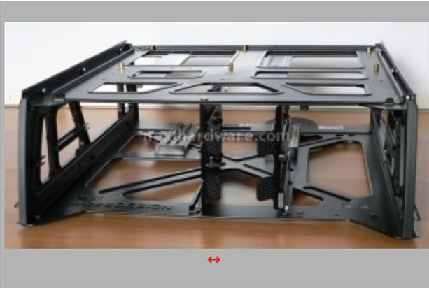
Ecco come appare il cassetto componenti rimosso dalla struttura portante dello Skeleton. Il case può essere già utilizzato in questa modalità trasformando il prodotto di Antec in un comune bench table.
