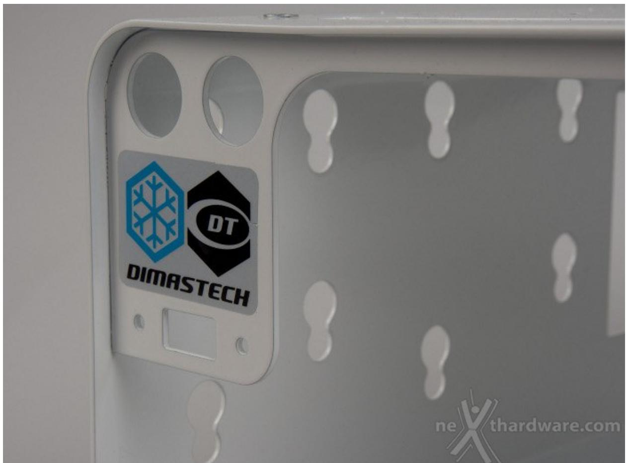
Sul lato sinistro della lamiera superiore abbiamo una presa di areazione in corrispondenza dell'alloggiamento dell'alimentatore e otto piccole asole che permettono di montare hard disk o SSD in modalità "on the fly" senza utilizzare il supporto interno.
