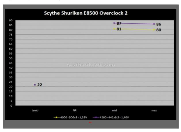
Temperature ancora in salita e nessun cedimento mostrato dal sistema, anche con temperature abbastanza alte. Non possiamo certo definire Shuriken, proprio per la sua concezione, un dissipatore particolarmente votato all'overclock, anche se il comportamento mostrato è di tutto rispetto.
