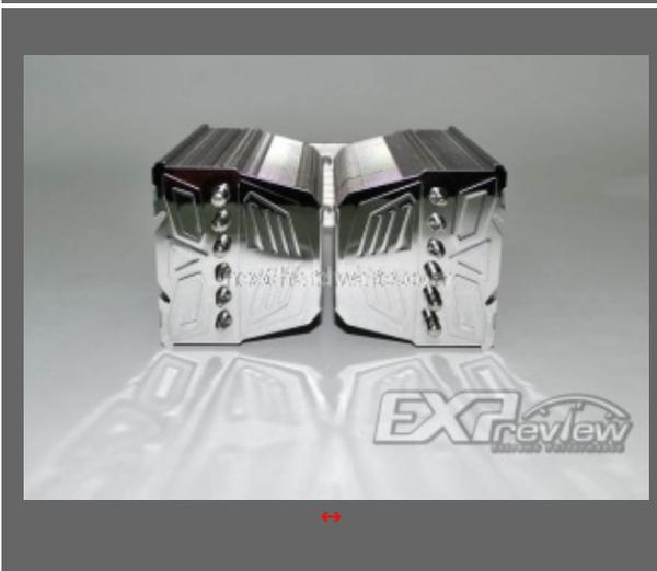
Prolimatech ha recentemente presentato la rev. b del dissipatore Megahalems, che fornisce una migliore compatibilità con le varie piattaforme aggiungendo il supporto al socket Intel LGA 1156. Il Megahalems Rev.B è dotato quindi di una piastra universale compatibile con i socket Intel 775, 1156 e 1366, e viene fornito con due serie di clip per l'installazione di due ventole.
