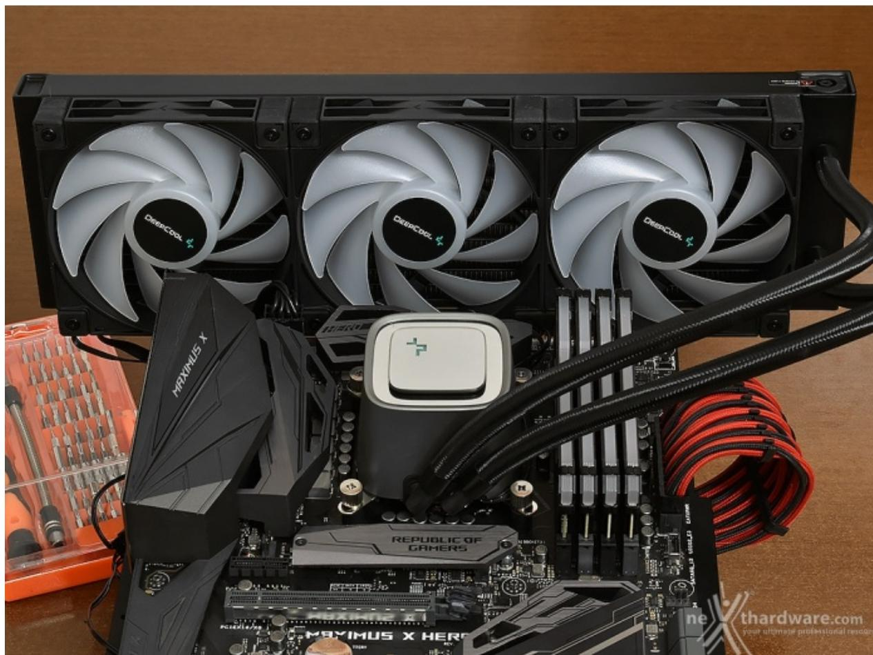
Segnaliamo che il produttore raccomanda il montaggio della pompa con i tubi orientati verso il basso così da ottenere le migliori prestazioni possibili.
