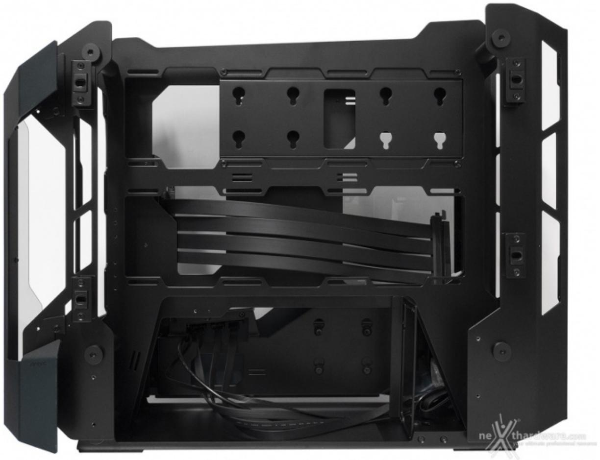
Estraendo la copertura inferiore in alluminio, la situazione sarà analoga a quanto visto precedentemente, con un telaio comprendente un supporto per drive da 2,5" o da 3,5".
