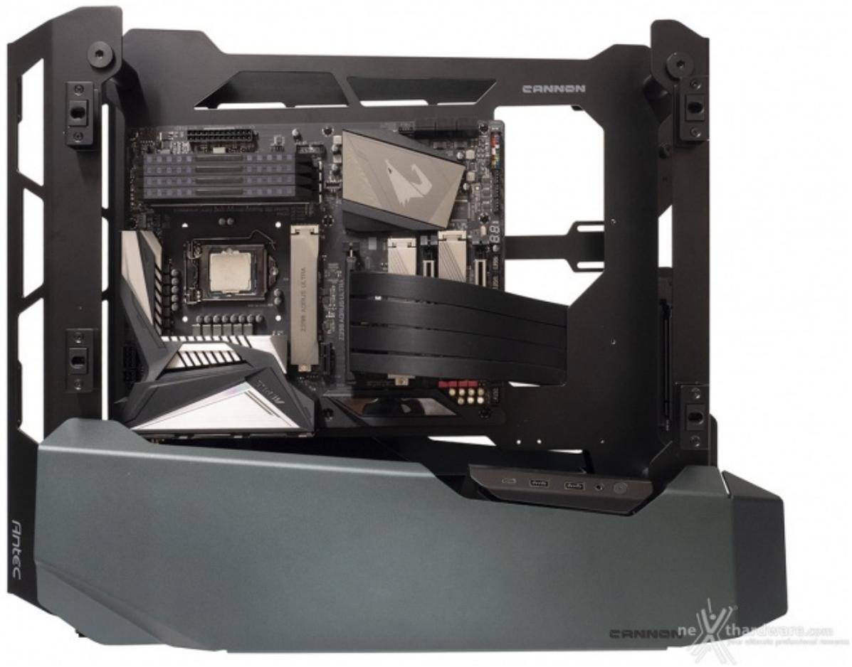
Il primo componente a trovare spazio è stata la scheda madre in formato ATX, facilmente installabile con le porte I/O rivolte verso il basso, quindi ruotata di 90↔° in senso antiorario.
