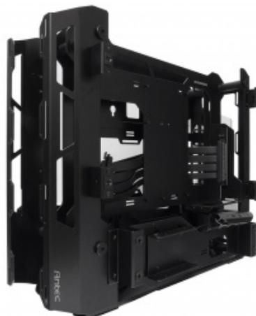
Rimuovendo anche la copertura in alluminio potremo accedere ad un cestello per drive da 2,5" o 3,5".
