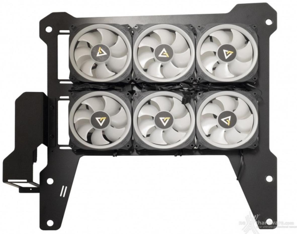
Successivamente abbiamo provveduto a smontare completamente il case per estrarre il pannello di destra e dotarlo di sei ventole da 120mm (puremento a fine dimostrativo dato che tale predisposizione è specificatamente pensata per radiatori o vaschette compatibili).
