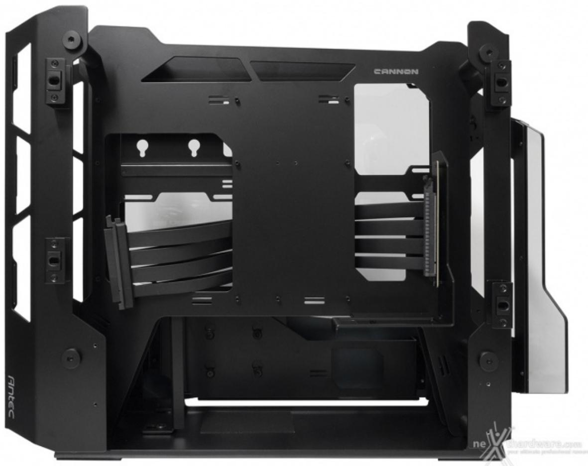
L'intera porzione del telaio può essere rimossa per avere accesso al vano alimentatore, in grado di contenere un'unità con una lunghezza massima di 270mm ed una gran mole di cavi.
