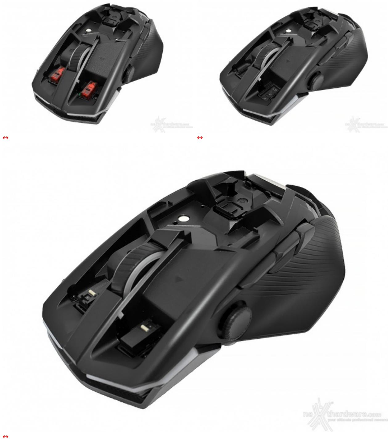
La scocca superiore del Chakram X può essere facilmente rimossa, così come i pulsanti principali, essendo composta da cover fissate alla struttura mediante un magnete.
