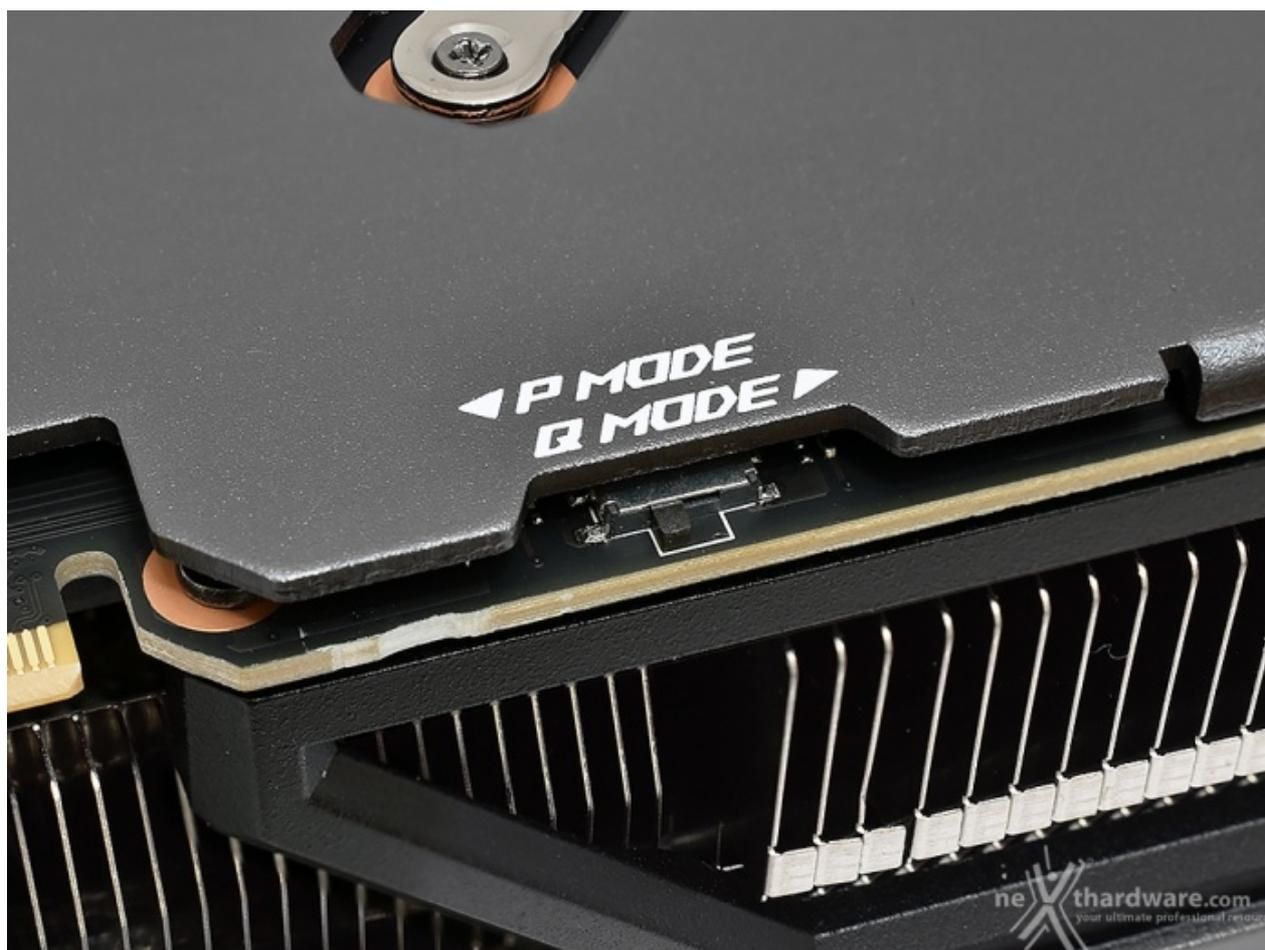
ASUS ha ovviamente dotato la TUF Gaming GeForce RTX 3090 Ti OC Edition del selettore del BIOS, disponibile in modalità Quiet, per favorire una rumorosità contenuta a discapito di temperature leggermente più elevate, o Performance, che incrementa il regime di rotazione delle ventole senza preoccuparsi del conseguente impatto acustico.
