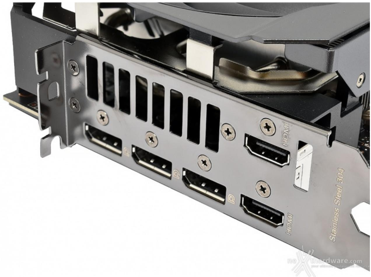
Il comparto delle connessioni è leggermente più fornito rispetto a quello del modello Founders Edition integrando, difatti, una HDMI 2.1 in più, per un totale di cinque porte: tre DisplayPort 1.4 e due HDMI 2.1.
