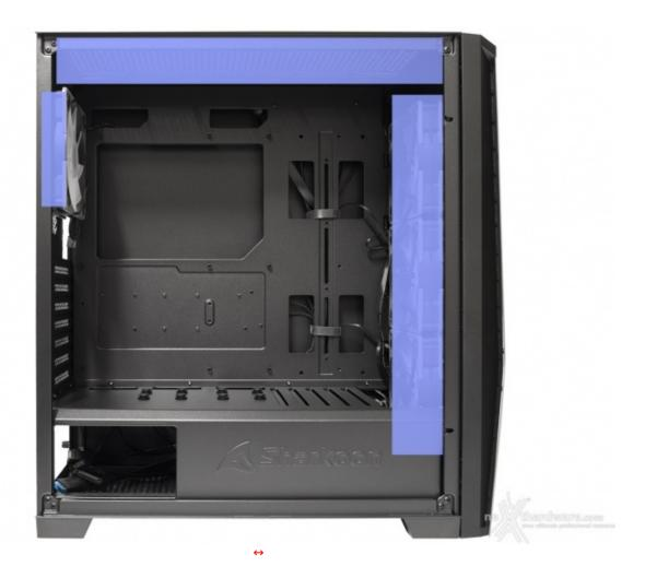
L'altezza massima a disposizione per un dissipatore ad aria per CPU è di 172mm, mentre coloro che vorranno affidarsi ad un sistema di raffreddamento a liquido potranno sfruttare a tale scopo tutte le predisposizioni per ventole, tuttavia l'installazione di un radiatore da 360mm sul top è possibile solo mettendo le ventole anteriori nella parte esterna del telaio, quindi tra l'acciaio e la copertura in mesh.
