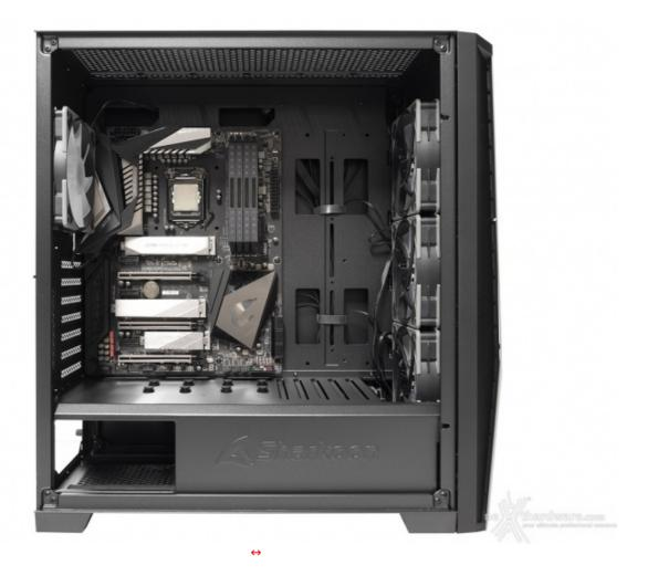
Trattandosi di un case particolarmente adatto per ospitare un sistema di raffreddamento ad aria, abbiamo deciso di installare una scheda madre in formato ATX completa di RAM e CPU raffreddata da un Noctua NH-D15.
