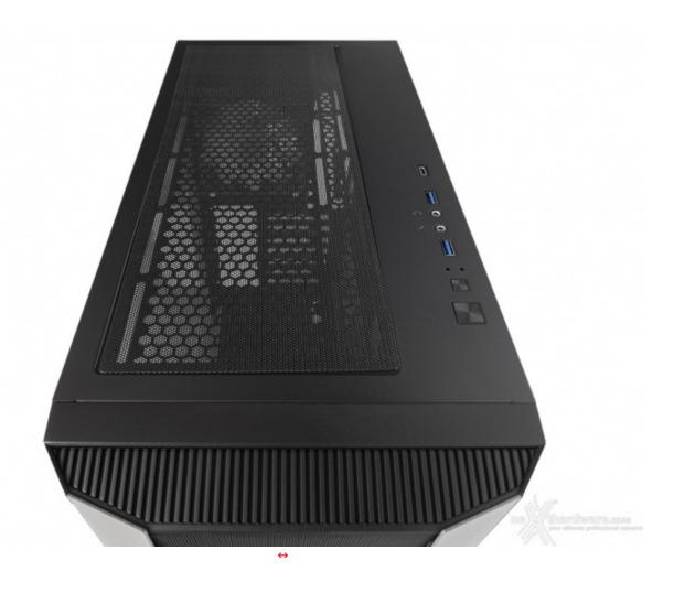
Spostandosi nella parte alta del case è possibile notare come la stessa risulti molto semplice, in quanto comprende solo un ampio filtro antipolvere ed il pannello di I/O composto da una porta USB Type-C (sempre apprezzata), due USB 3.0, jack audio per cuffie e microfono, LED di stato ed i pulsanti di accensione e modifica del sistema di illuminazione (utilizzabile in alternativa come reset).
