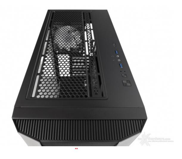
Il filtro superiore è posto a protezione di una seconda predisposizione per ventole (tre da 120 mm o due da 140 mm), in questo caso non presenti.
