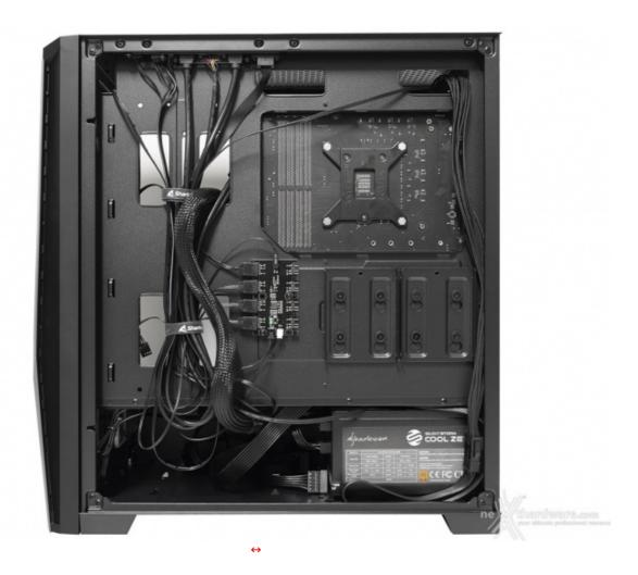
Spostandoci sul lato destro del case, abbiamo posizionato l'alimentatore Sharkoon Silent Storm Cool Zero da 850W all'interno del proprio scomparto ed effettuato il cablaggio che, a dirla tutta, è stato abbastanza ostico data l'assenza di ganci per il fissaggio di fascette e asole gommate coprenti.
