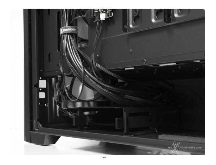
All'interno del vano alimentatore è presente un cestello con slitta per un drive da 2,5 o 3,5" ma, in realtà , una seconda unità potrà essere installata nella parte alta.
