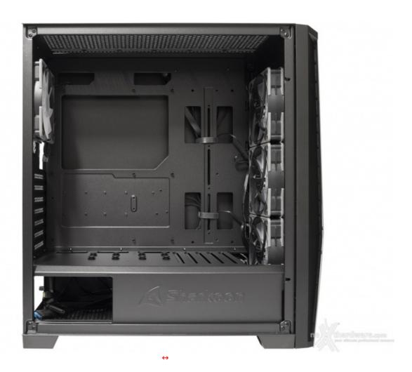
Il vassoio dedicato al contenimento della scheda madre in formato E-ATX o inferiore vede, centralmente, un'ampia apertura rettangolare per poter agire sul sistema di ritenzione dei sistemi di raffreddamento aftermarket ed è contornato da sei fori per il passaggio dei cavi, purtroppo tutti privi di guarnizioni in gomma.
