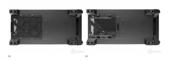
Esaminando la base è possibile notare come la "zona alimentatore" sia dotata di una griglia d'aerazione coperta da un filtro antipolvere di facile estrazione.
