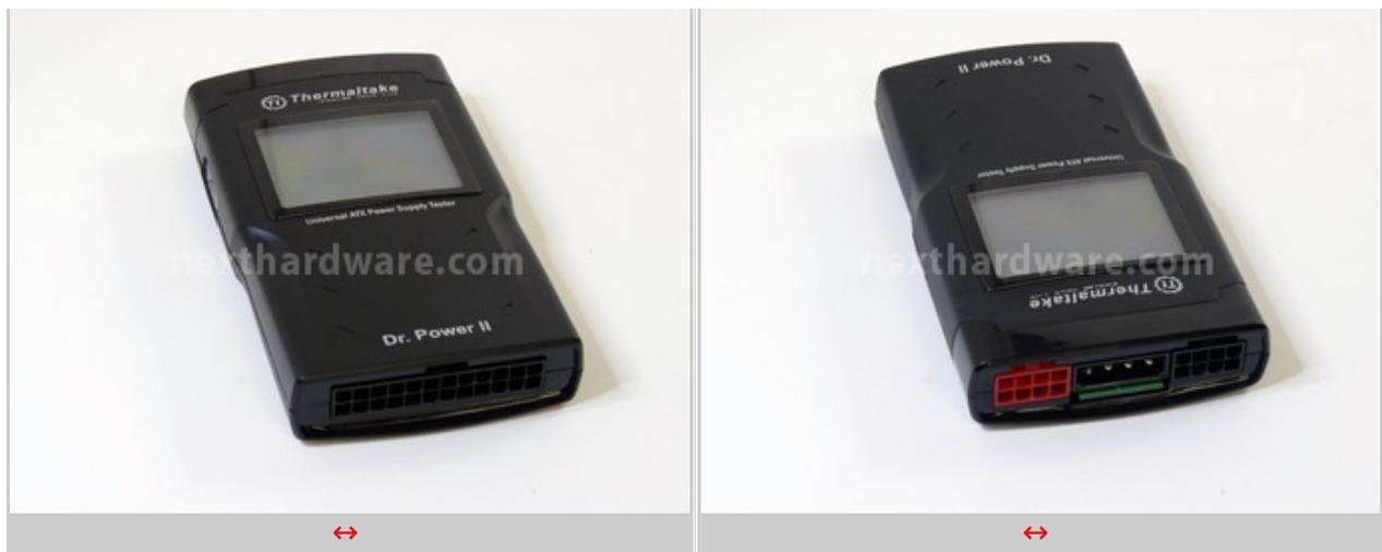
Nella parte superiore e inferiore del dispositivo troviamo invece i connettori di collegamento per la diagnosi in standard ATX.
