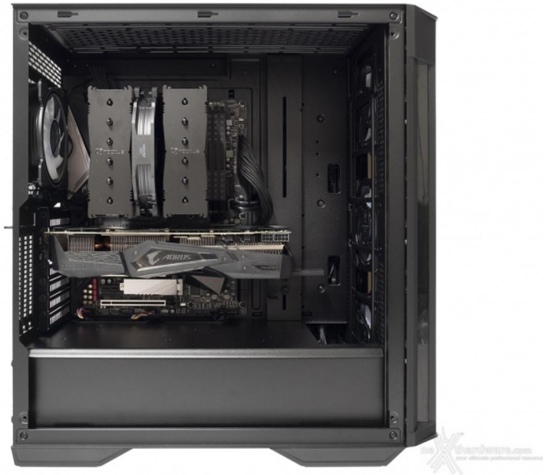
Successivamente è toccato alla scheda video, anch'essa montata senza difficoltà e bloccata tramite il GPU Holder preinstallato.
