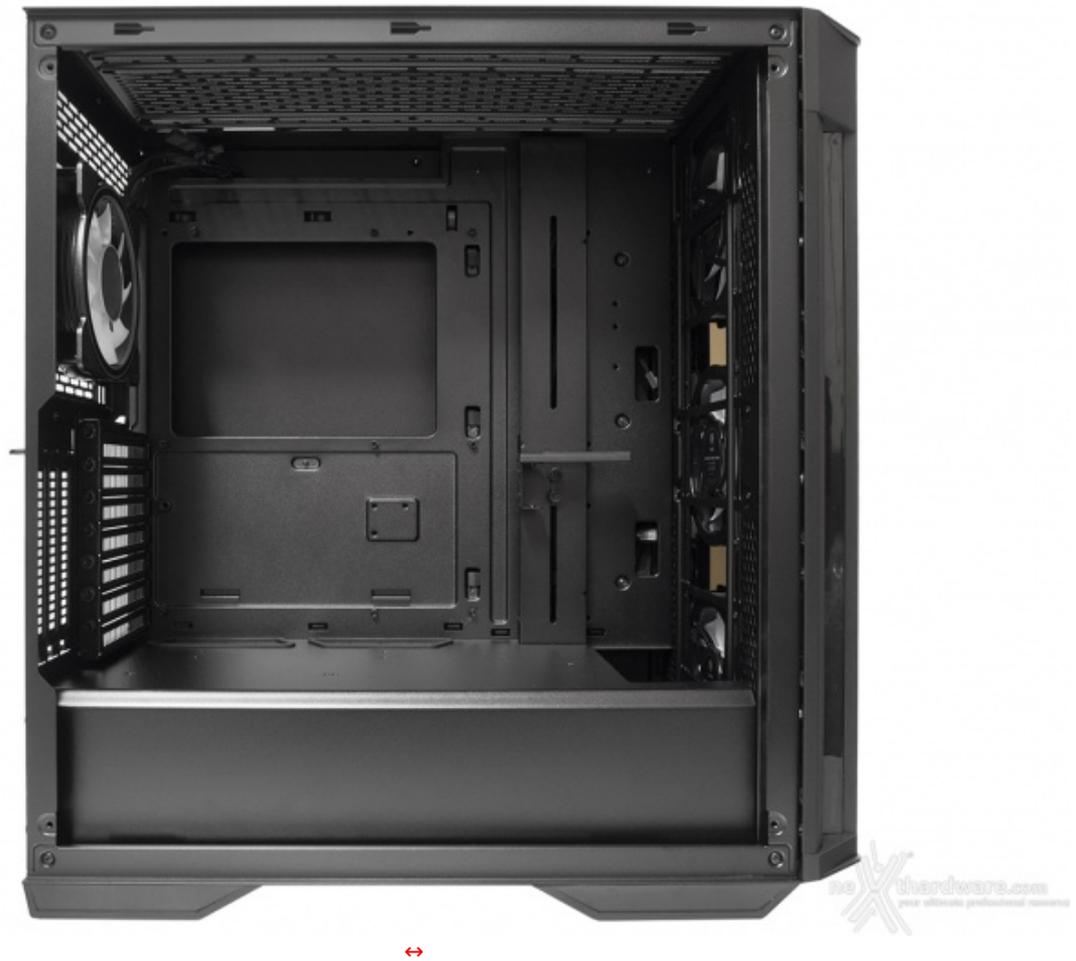
Il piatto mainboard, che si estende fino al frontale, è molto razionale e vede, in corrispondenza della zona CPU, un ampio scasso per l'installazione e la manutenzione di dissipatori aftermarket.
