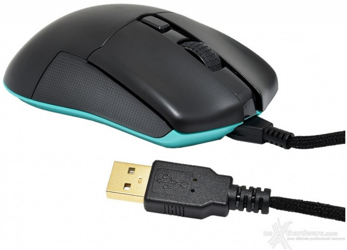
In dotazione viene fornito un cavo paracord removibile da 1,8 metri con connettori USB e USB Type-C, ultraleggero ed estremamente flessibile, così da garantire il massimo delle performance sia in modalità cablata che wireless.
