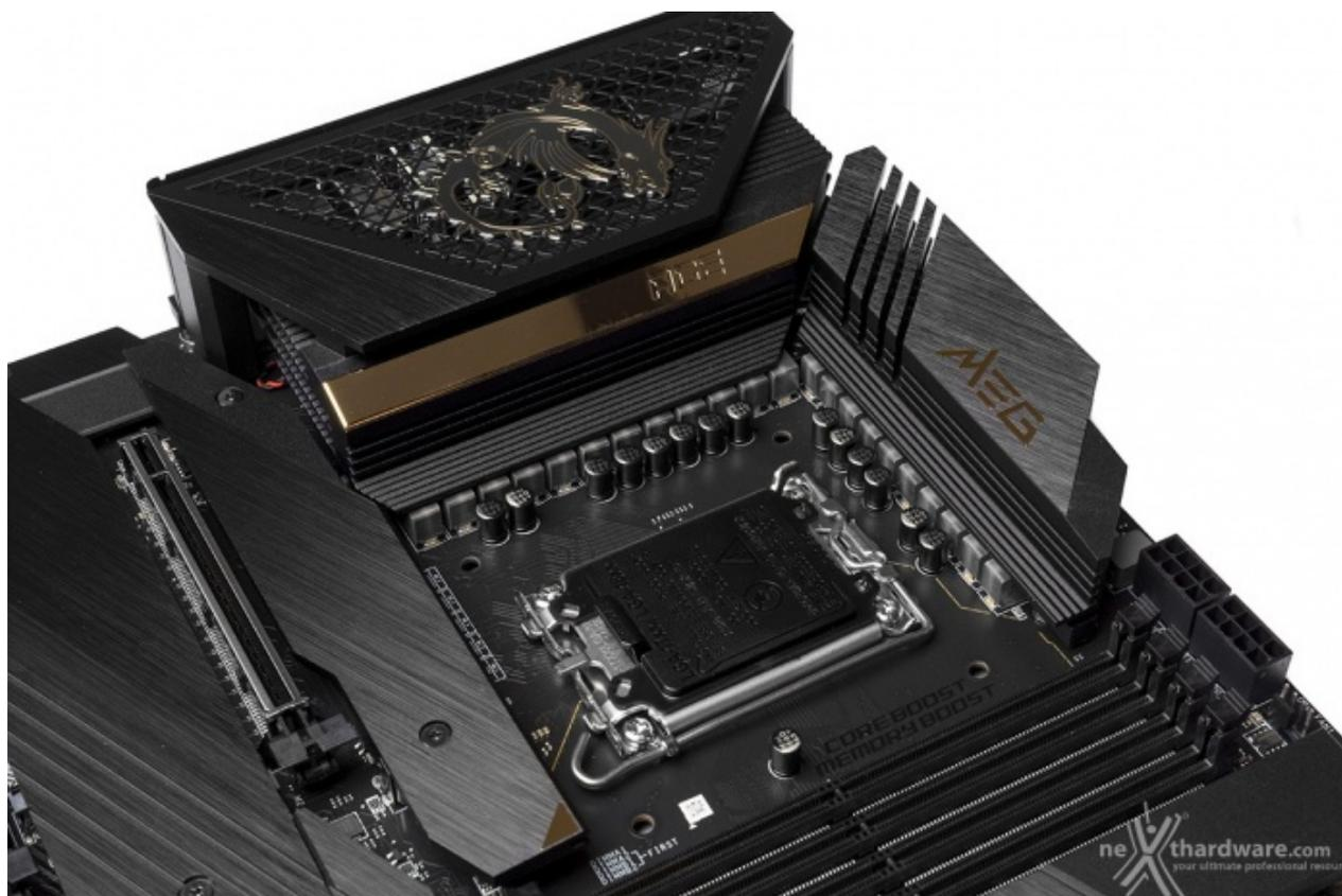
Come per ogni scheda madre che supporti Alder Lake, la MEG Z690 ACE utilizza il socket Intel LGA 1700 il quale, a differenza delle generazioni precedenti di forma quadrata, è rettangolare con dimensioni pari a 45x37,5mm ed una Z-height (altezza dell'IHS dal PCB) inferiore ed un interasse dei fori di 78x78mm, rendendo necessaria l'adozione di sistemi di installazione e montaggio espressamente dedicati alla nuova piattaforma.
