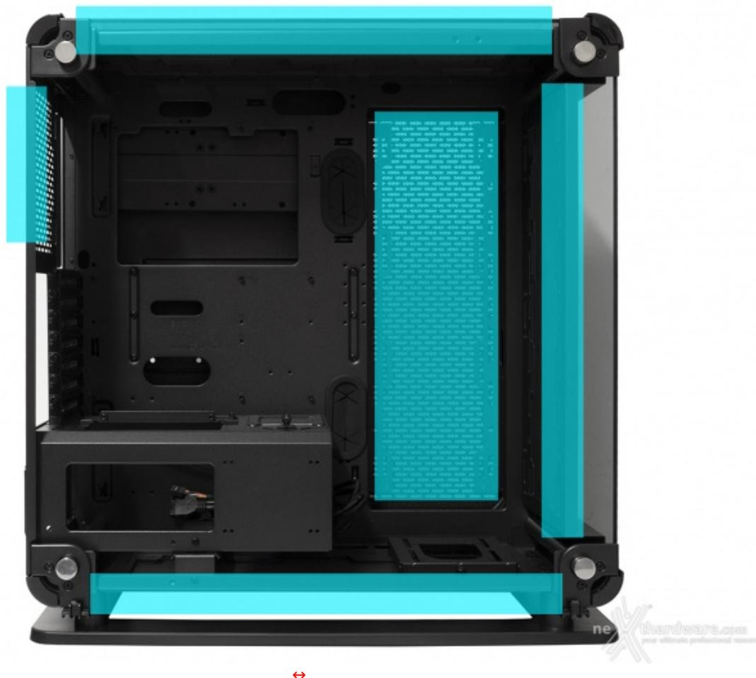
Tutte le predisposizioni potranno essere utilizzate anche per l'installazione di radiatori facenti parte di sistemi di raffreddamento a liquido custom, senza particolari restrizioni a parte sul fondo, data la presenza dell'alimentatore.
