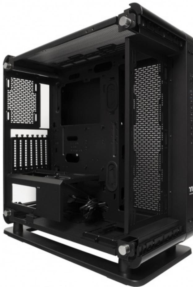
Tenendo fede alla serie d'appartenenza, anche il Core P6 TG ARGB può essere utilizzato in modalità Open Air, ovvero privato delle varie facciate così da utilizzarlo come piattaforma di test o benchmark.
