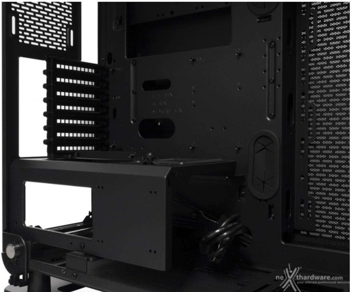
Se volessimo esporlo completamente potremmo rimuoverla del tutto o, addirittura, utilizzare i supporti in dotazione per installarlo ruotato di 90↔°, operazione che però sconsigliamo vivamente dato che ridurrebbe lo spazio a disposizione per la scheda madre, limitandolo ai modelli microATX.
