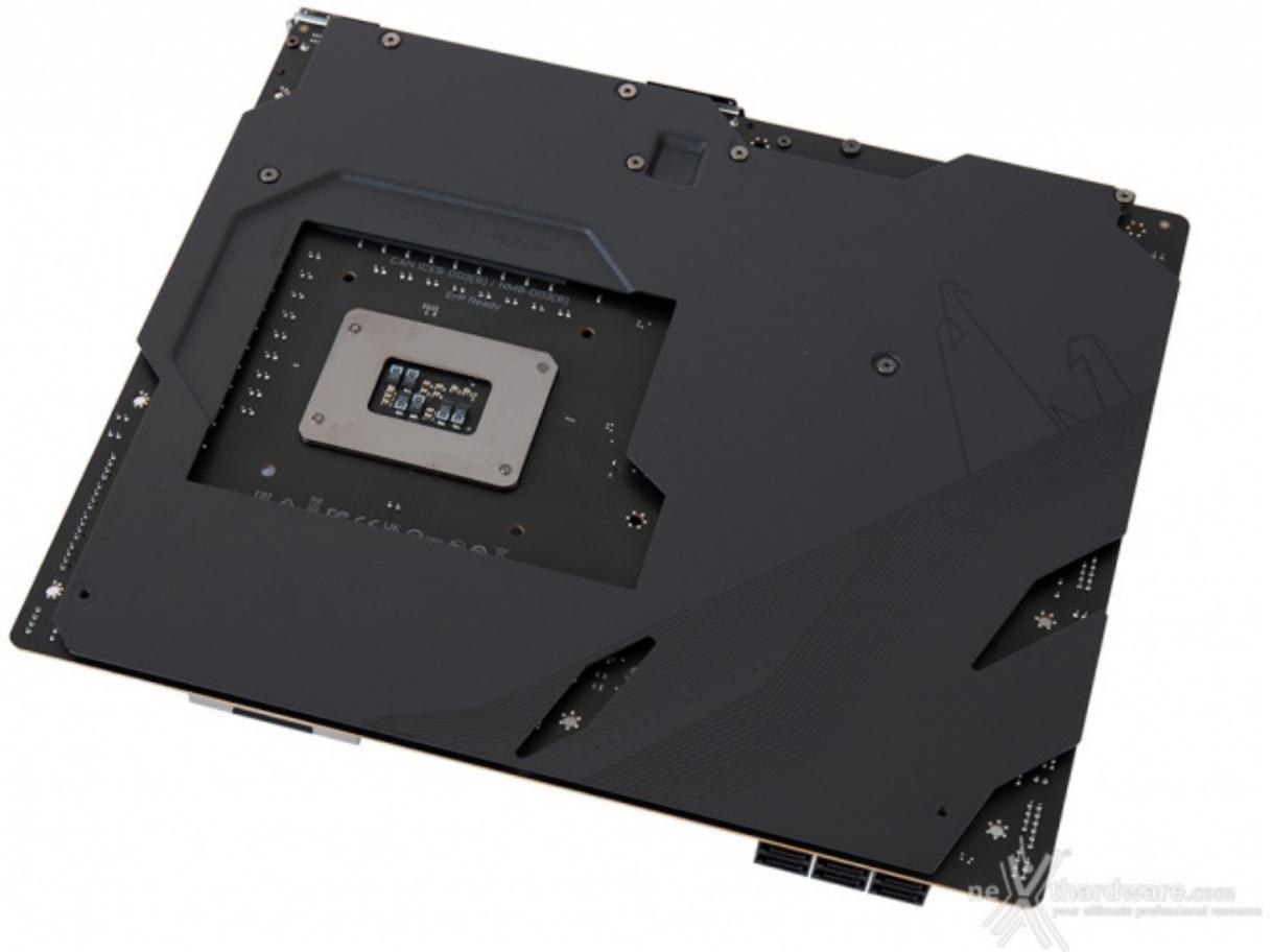
Sul retro notiamo subito la presenza di un imponente armatura in metallo avente la duplice funzione di irrobustire il PCB e favorire il raffreddamento dei numerosi componenti ivi presenti.
