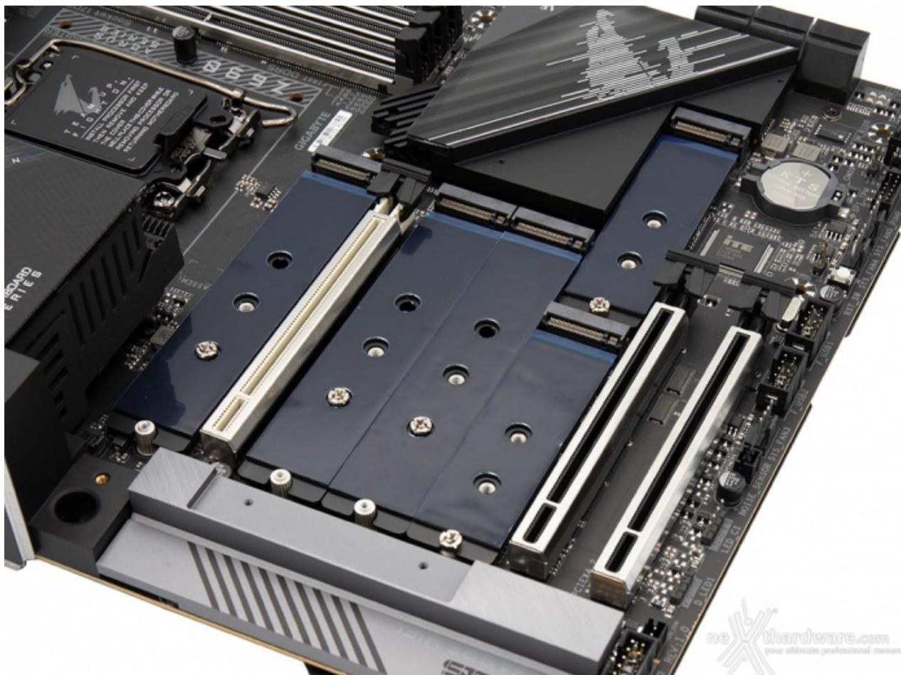
La Z690 AORUS MASTER è equipaggiata con cinque connettori M.2 PCIe posizionati, rispettivamente, il primo (M2A\_CPU), pilotato direttamente dalla CPU, nello spazio compreso tra il socket ed il primo slot PCIe x16, il secondo (M2P\_SB), il terzo (M2Q\_SB), il quarto (M2C\_SB) ed il quinto M2M\_SB, nello spazio tra il primo ed il secondo slot PCIe x16 (questi ultimi quattro gestiti dal PCH Z690).
