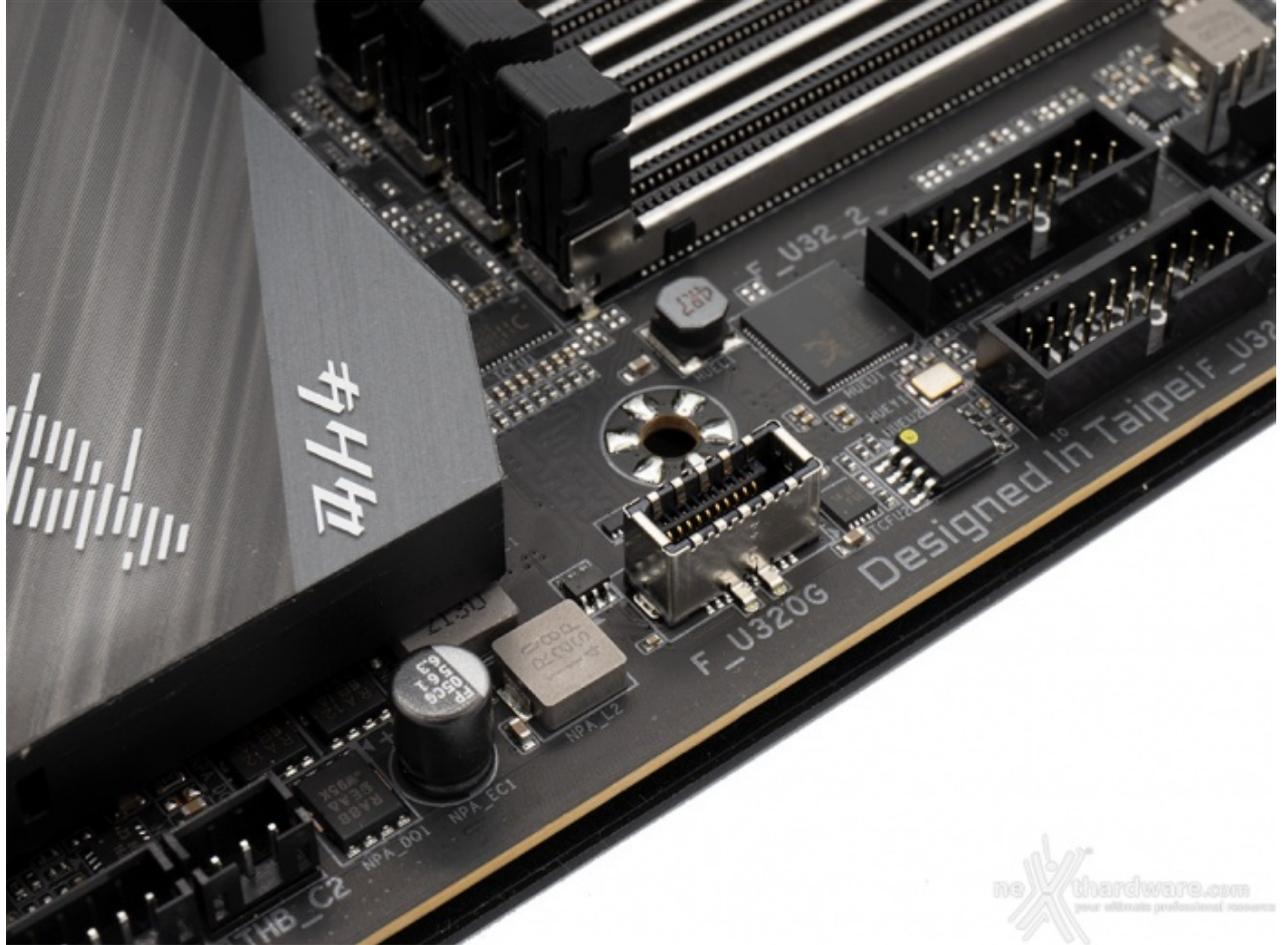
La Z690 AORUS MASTER dispone di un header USB 3.2 Gen 2x2, pilotato dal PCH Intel Z690, che permette di utilizzare questa tipologia di connessione nei pannelli di I/O presenti sugli chassis di ultima generazione.
