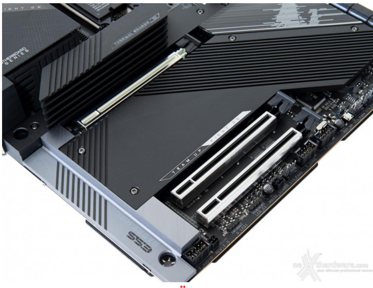
L'immagine in alto ci mostra la dotazione di slot PCIe composta da un PCIe 5.0 x16 pilotato dalla CPU e due PCIe 3.0 x16 gestiti invece dal chipset Z690, funzionanti, rispettivamente, in modalità x16, x4 e x4.
