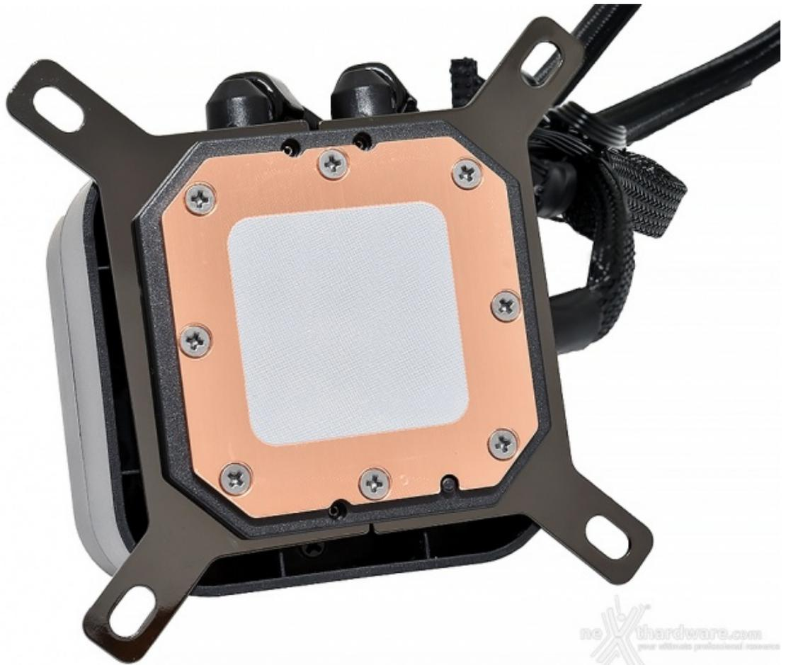
Analogamente alla maggior parte degli All-in-One presenti in commercio, anche l'iCUE H150i ELITE LCD presenta sul cold plate un pad termoconduttivo preapplicato di forma quadrata che, come sempre, consigliamo di rimuovere e sostituire con una pasta termica di buon livello.
