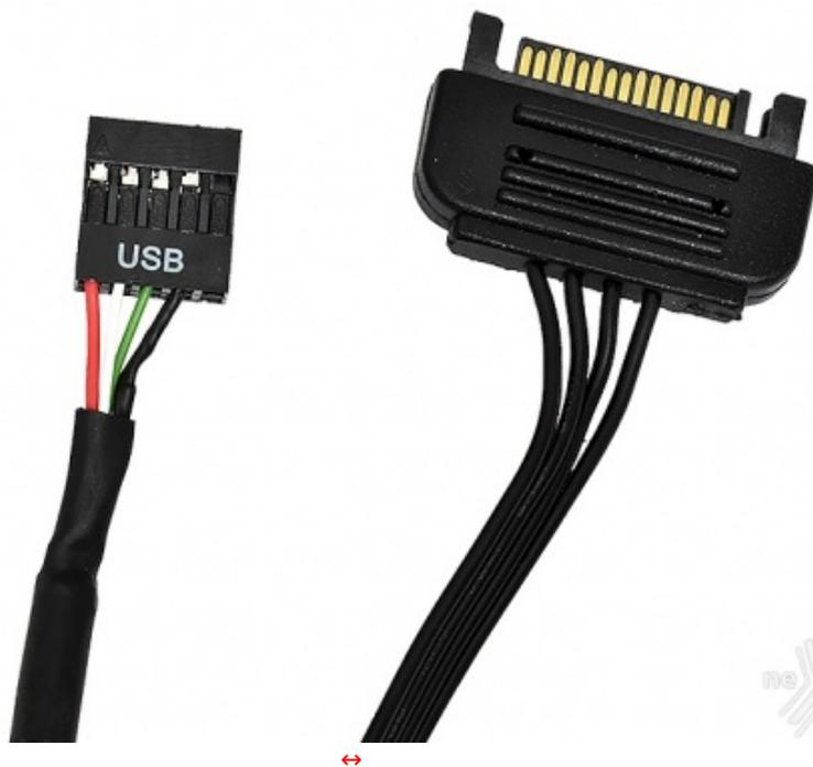
La cavetteria in uscita dal Commander CORE è composta unicamente da due connettori, un SATA POWER che si occuperà di garantire i 12V necessari al corretto funzionamento di tutto il sistema ed un connettore USB 2.0 per interfacciarsi con il software di gestione iCUE.
