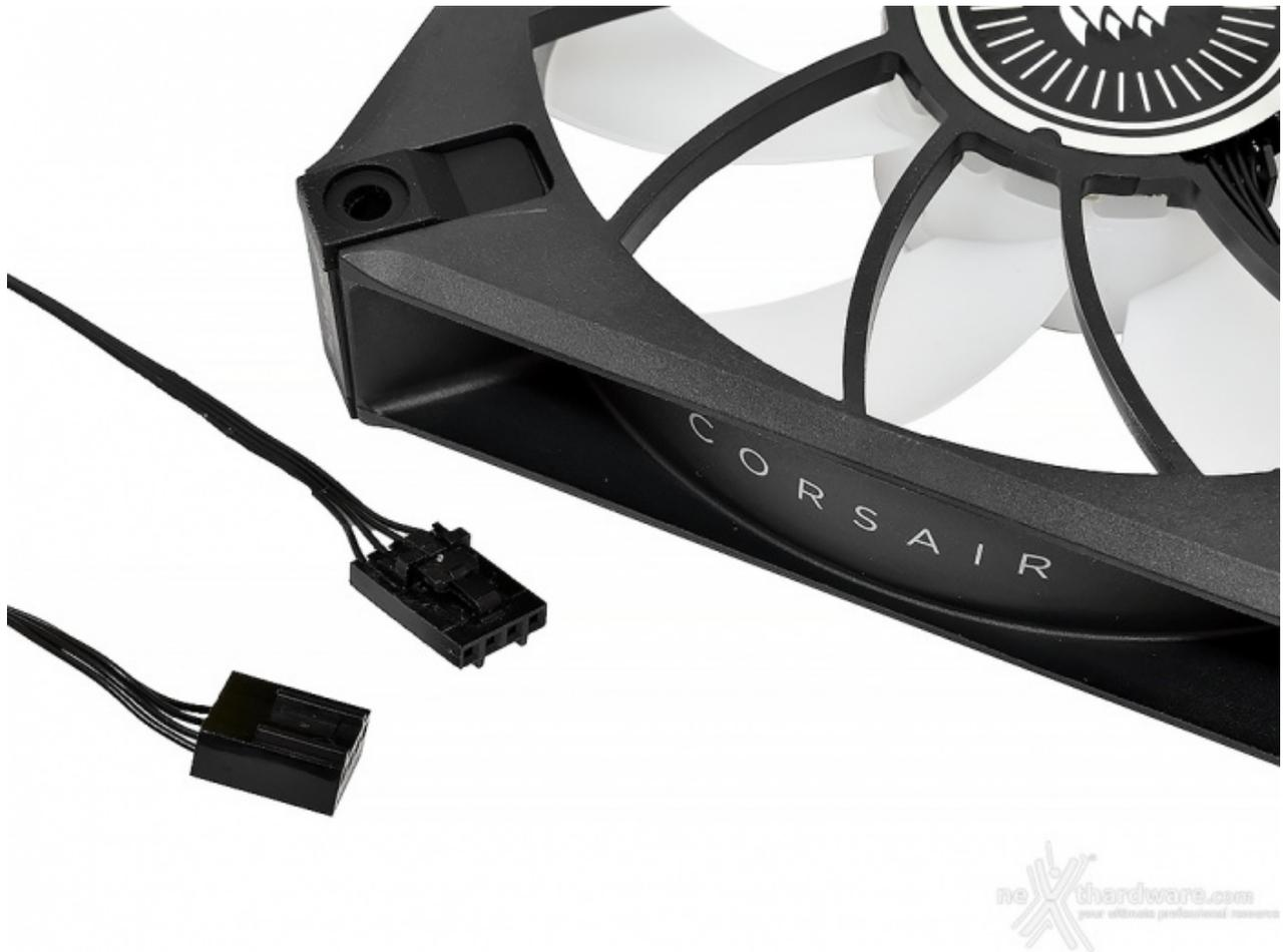
Ciascuna delle tre ventole è dotata, ovviamente, dei connettori 4pin PWM e 4pin RGB da collegare, direttamente, alle rispettive porte presenti sul controller.
