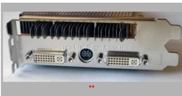
La scheda è dotata di due connettori DVI-Dual Link e di una connessione multifunzione. Le lamelle del secondo radiatore sono esterne al case cercando di facilitare lo scambio termico con l'ambiente circostante.
