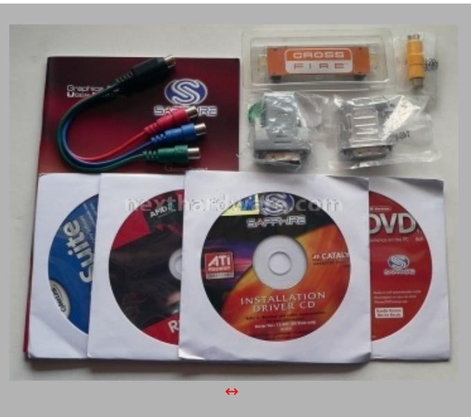
Il bundle della HD4870 Toxic di Sapphire è composto da: 1 adattatore DVI-VGA, 1 adattatore DVI-HDMI con audio, 1 bridge CrossFireX, 1 adattatore Component, 1 adattatore Composito, 1 disco di Driver (consigliamo di installare sempre gli ultimi driver ATI Catalyst dal sito web del produttore), 1 copia di Power DVD, 1 copia di CyberLink DVD Suite, 1 disco di demo Ruby ROM e una licenza di Futuremark 3DMark Vantage Advanced.
