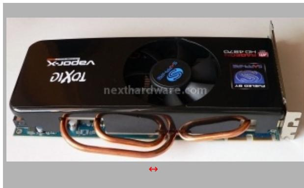
L'ingombro della Toxic eccede la dimensione standard delle schede PCI-E, sarà quindi necessario valutare attentamente le dimensioni del proprio case, per non incontrare incompatibilità meccaniche. L'heatpipe frontale intralcia purtroppo la connessione del secondo connettore CrossFireX, a detta di Sapphire, questo non dovrebbe essere un problema, infatti le nuove schede madri supportano la modalità Peer to Peer per il CrossFireX necessitando quindi di un solo connettore bridge.
