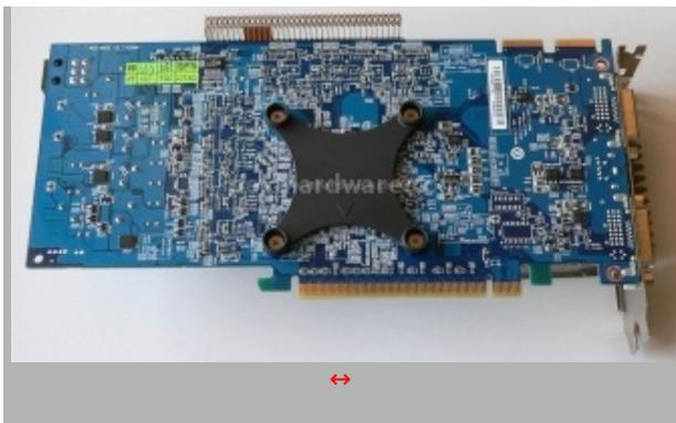
Sul retro della scheda è visibile un grosso sistema di ancoraggio in materiale plastico, questa soluzione si è resa necessaria al fine di garantire un solido ancoraggio del dissipatore, che non è fissato con alcuna altra vite.
