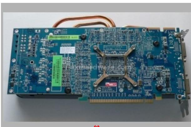
Il PCB della Toxic è prodotto da Sapphire ed è caratterizzato dalla tipica colorazione blu che distingue i prodotti custom di questo produttore. Il design non è molto differente da quello reference di ATI, non sono infatti presenti componenti sul lato posteriore della scheda, tutti gli 8 moduli di memoria GDDR5 sono installati in prossimità della GPU RV770 XT.
