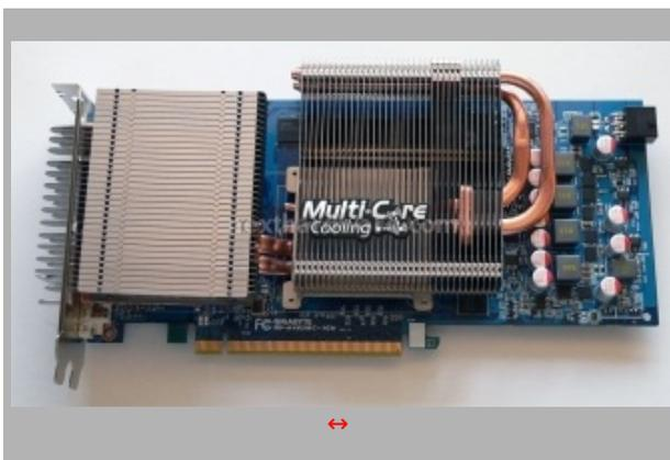
La HD4850 proposta da Gigabyte è dotata dell'innovativo dissipatore Multi-Core Cooling. Rispetto alle soluzioni concorrenti, non richiede alcuna ventola di raffreddamento garantendo però simili temperature di esercizio senza produrre alcun rumore. Il design è a doppio slot, compromesso necessario per poter sfruttare una maggior superficie di scambio termico. La scheda è dotata di connessione PCI-E 2.0 e di ben 1 GB di memoria GDDR3.
