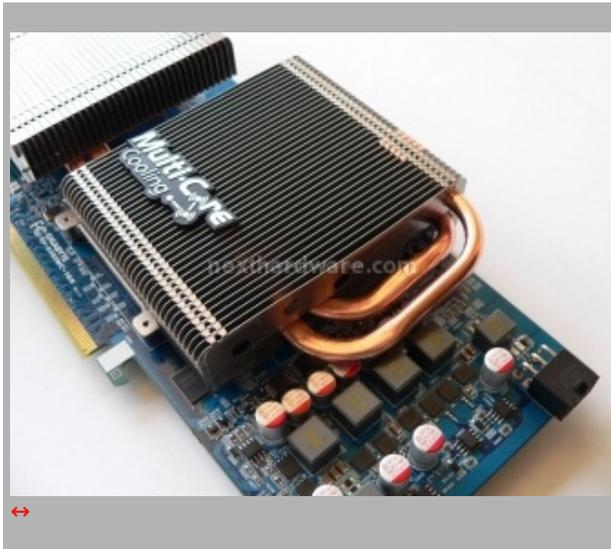
Il dissipatore Multi-Core Cooling prende il nome dalla sua particolare struttura divisa in 3 aree. Zona di contatto con la GPU, prima connessione delle HeatPipe al dissipatore e seconda connessione delle stesse in un altro punto del radiatore.
