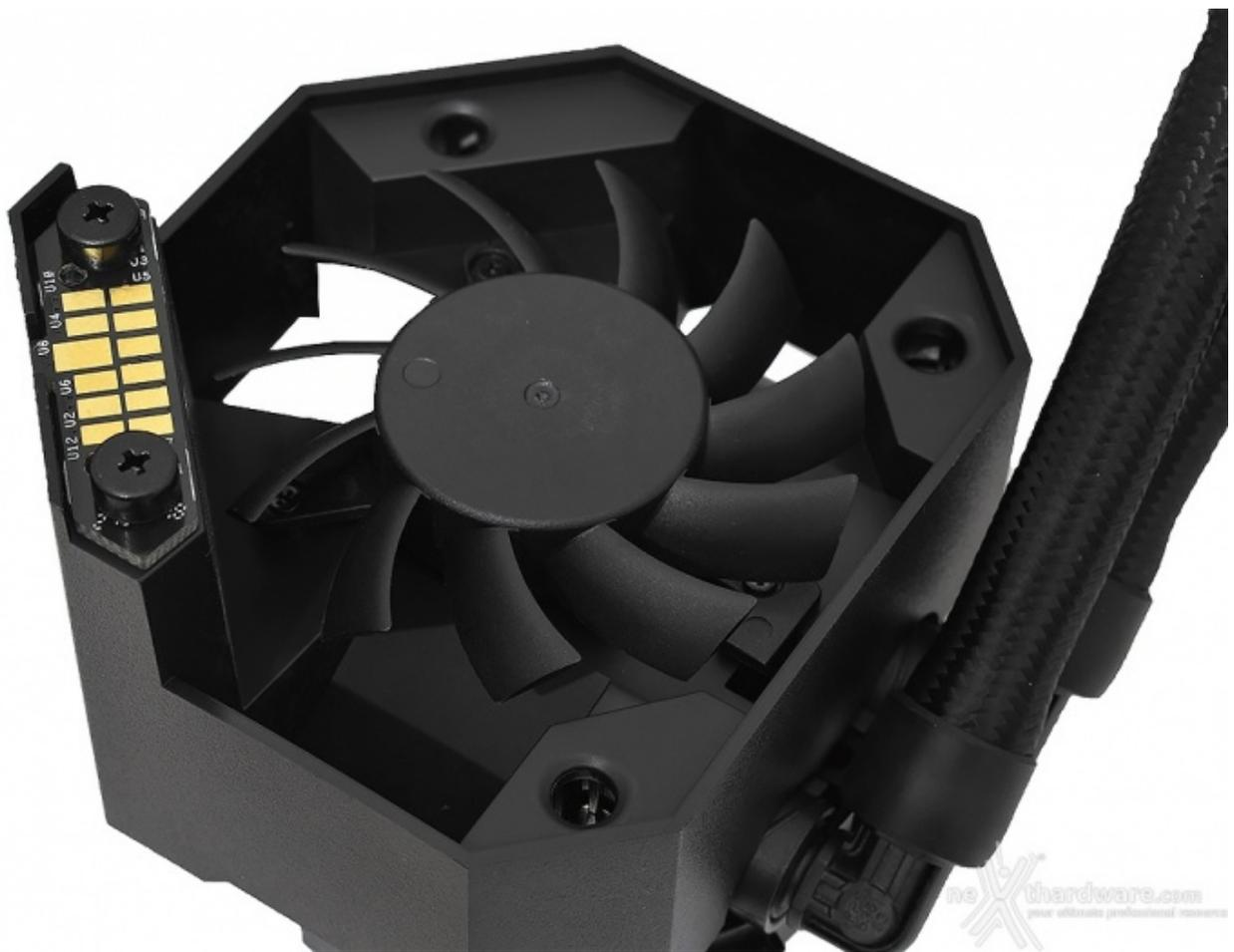
Analogamente a quanto visto sul primo modello del RYUJIN, anche in questo caso al di sopra della pompa è posizionata una piccola ventola da 60mm.
