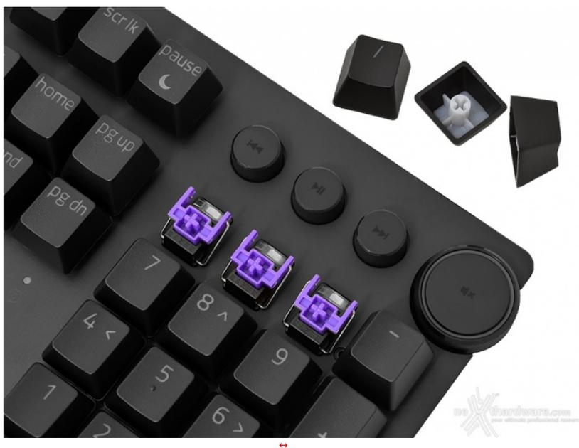
Una volta rimossi i keycaps, operazione estremamente semplice essendo gli switch esposti, avremo pieno accesso ai nuovi attuatori ottici di seconda generazione.
