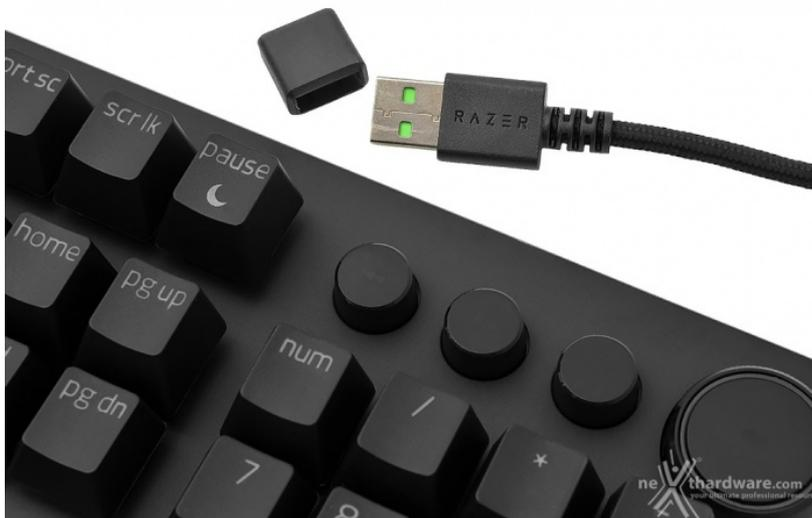
Il collegamento della tastiera al PC avverrà tramite un cavo in fibra intrecciata di pregevole fattura, dotato di connettore USB 2.0.
