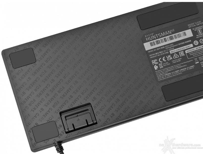
La base di appoggio accoglie ben quattro pad in gomma disposti agli angoli e, centralmente, ulteriori due pad di forma rettangolare per garantire la migliore stabilità di appoggio.
