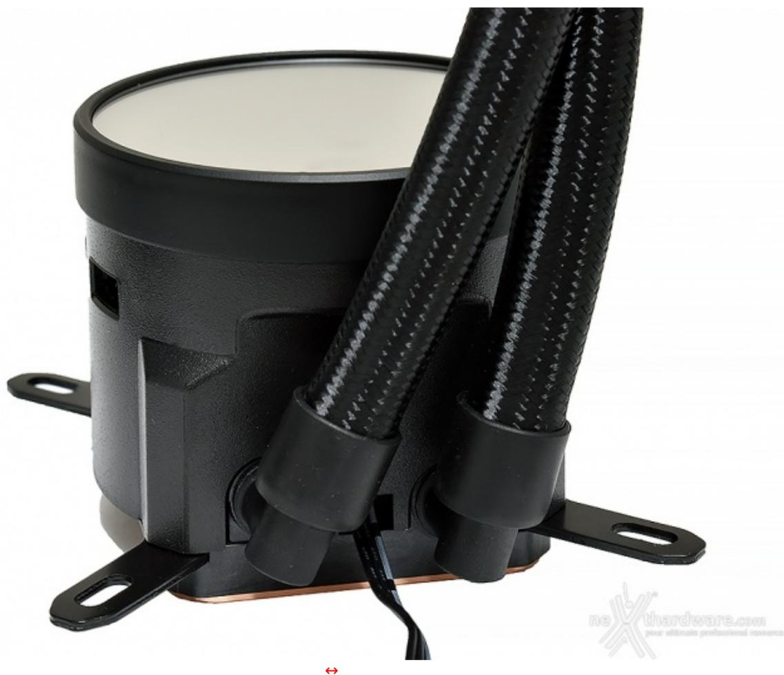
I tubi sono collegati all'unità principale tramite due raccordi in plastica a 90° particolarmente resistenti, che è possibile ruotare per adattarli ad ogni tipo di case.
