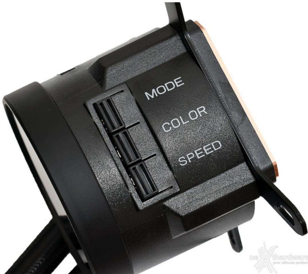
Una delle novità presentate da Thermalright per la propria linea di AiO TOUGHLIQUID è la presenza di un controller dedicato alla gestione dell'illuminazione ARGB, posto all'interno del blocco pompa/waterblock.↔
