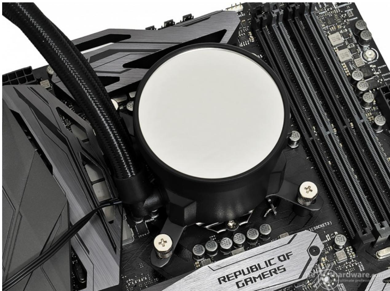
A questo punto sarà sufficiente posizionare correttamente l'unità principale e fissare il tutto con le quattro viti a molla in metallo, cercando di esercitare una pressione il più omogenea possibile su tutti i lati.
