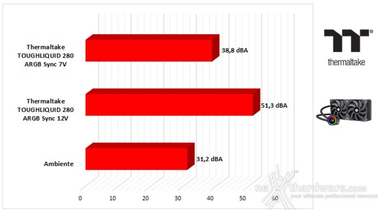
I risultati in termini di rumorosità ottenuti dal TOUGHLIQUID 280 ARGB Sync con le ventole impostate alla velocità minima sono buoni, appena 38,8dBA a 30cm di distanza; mentre, a 2000 RPM le TOUGHFAN 14 sono la causa principale degli oltre 50 dBA registrati, al contrario della pompa che non si fa sentire particolarmente.↔
