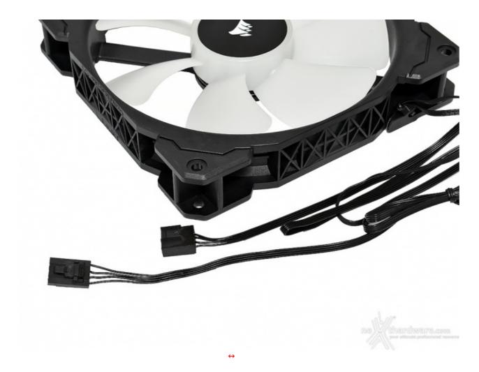
Ciascuna delle tre ventole è dotata, ovviamente, dei connettori femmina (4pin PWM e 3pin RGB) da collegare direttamente alle rispettivi porte presenti sul controller.
