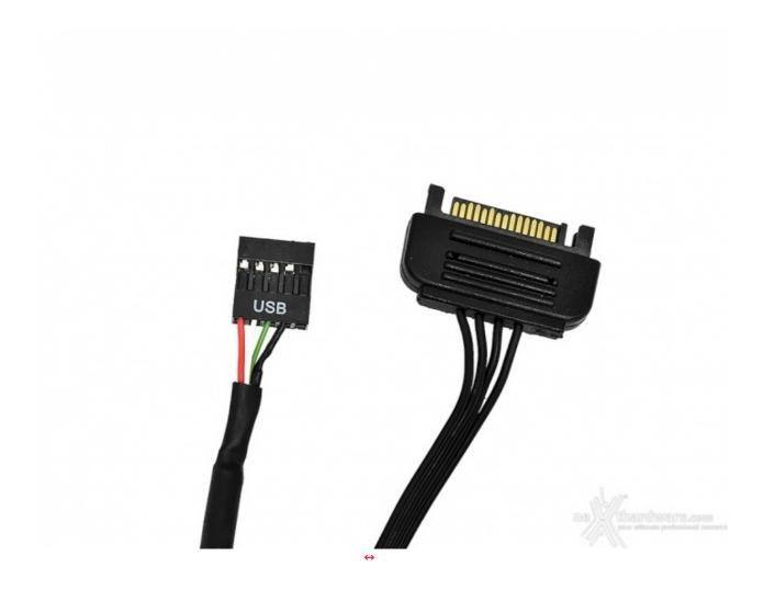
La cavetteria in uscita dal Commander CORE è composta unicamente da due connettori: un SATA POWER si occuperà di garantire i 12V necessari al corretto funzionamento di tutto il sistema ed un connettore USB 2.0 per interfacciarsi con il software di gestione iCUE.
