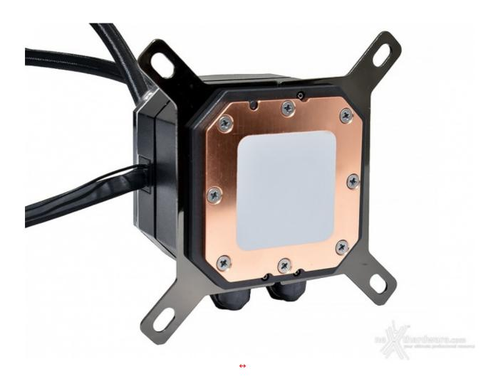
Analogamente alla maggior parte degli All-in-One presenti in commercio, anche l'iCUE H170i ELITE CAPELLIX presenta sul cold plate un pad termoconduttivo preapplicato di forma quadrata che, come sempre, consigliamo di rimuovere e sostituire con una pasta termica di buon livello.
