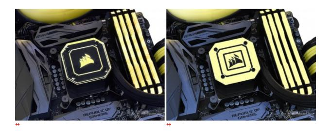
Per ottenere un effetto luminoso ancora più consistente, basterà sostituire la piastra superiore del waterblock con quella totalmente trasparente fornita in confezione.
