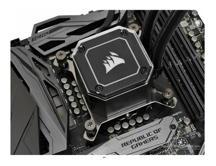
A questo punto sarà sufficiente posizionare il blocco pompa/waterblock curandosi di inserire correttamente le viti attraverso le staffe di ritenzione per andarle a fissare, poi, con i quattro bulloni in metallo cercando di esercitare una pressione omogenea in tutti i punti.
