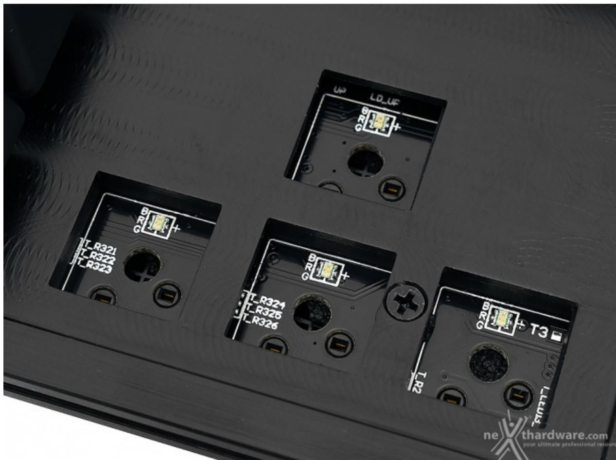
Come si può notare chiaramente dalla foto in alto, ciascun socket è pensato per ospitare switch meccanici a 3 pin, quindi qualora volessimo utilizzare dei 5 pin saremo costretti a tagliare i due pin in plastica in eccesso.
