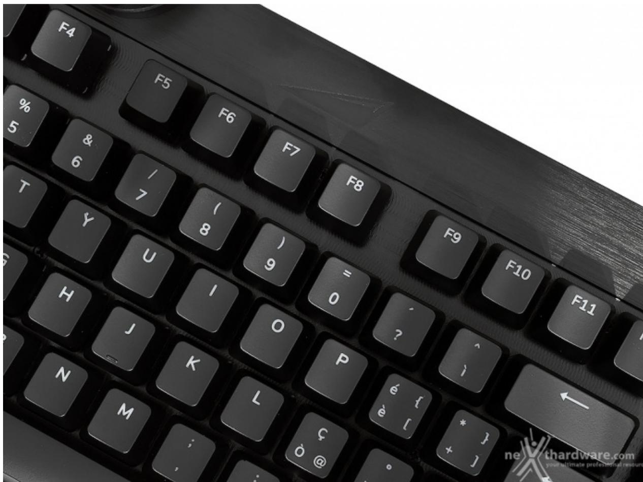
I keycaps forniti in dotazione sono di tipo single-shot in ABS e si presentano con un font facilmente leggibile di dimensioni generose.
