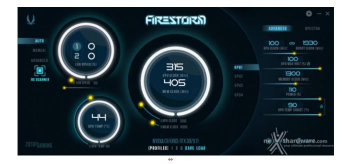
L'overclock massimo raggiunto sulla ZOTAC GeForce RTX 3070 Ti AMP Holo è stato di +100MHz sulla GPU e di +1300MHz sulla frequenza complessiva delle GDDR6X
