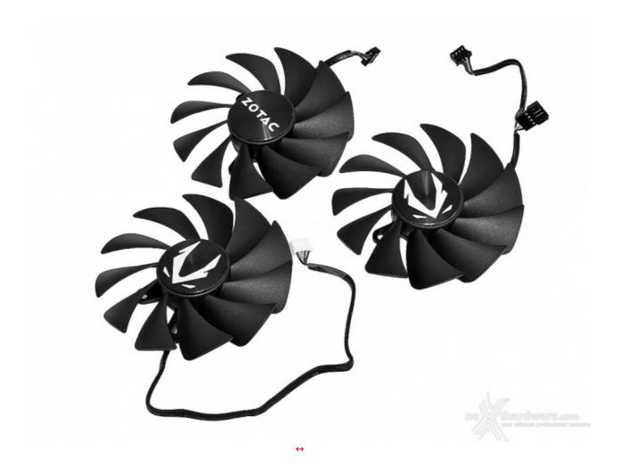
Per rimuovere le tre ventole dalla struttura sarà necessario svitare quattro viti ciascuna; le unità , prodotte da Apistek (GA92S2U), sono di tipo dual bearing, operano a 12V con un assorbimento pari a 0,46A.
