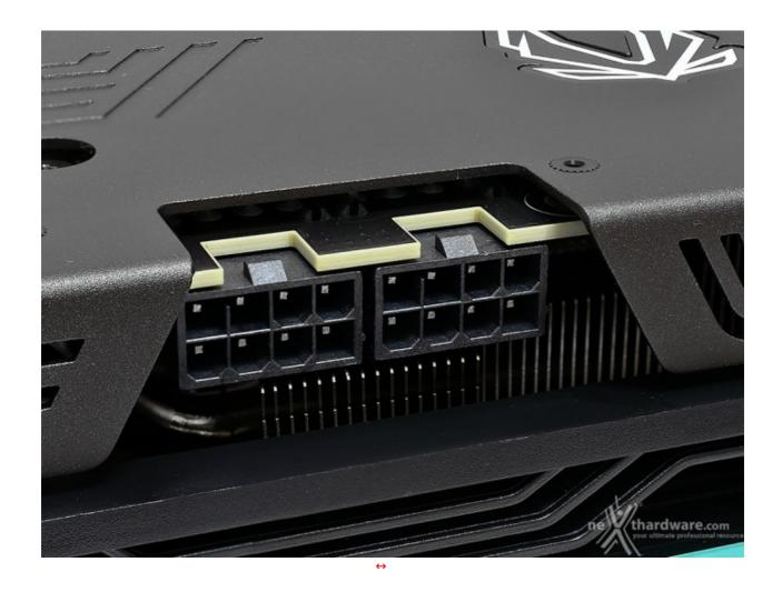
A differenza del modello Founders Edition, che adotta un singolo connettore Micro-Fit 3.0 a 12 pin, la RTX 3070 Ti AMP Holo si affida a due connettori PEG da 8 pin, più che sufficienti per soddisfare le esigenze energetiche della scheda anche in caso di overclock.
