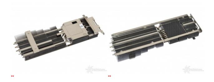
Il sistema di raffreddamento è il collaudato ZOTAC IceStorm 2.0, utilizzato, con alcune lievi differenze strutturali, anche per la serie 2000, che consta, oltre delle ventole sopracitate, di un robusto dissipatore costituito da un numero considerevole di alette in alluminio particolarmente fitte, attraversate da sei heatpipes in rame con un diametro di ben 8mm.
