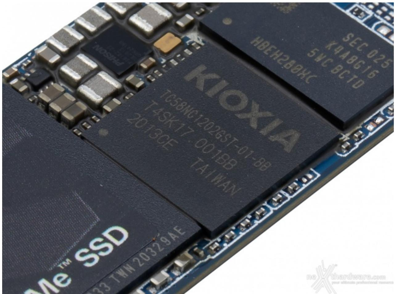
Il controller utilizzato da KIOXIA per questo SSD è il collaudato Toshiba TC58NC1202GST di cui il produttore non ha mai reso pubbliche le specifiche complete, se non il fatto che utilizza quattro canali ed è compatibile con il protocollo NVMe 1.3c.
