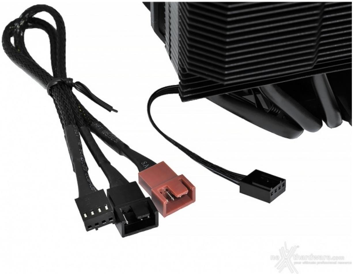
Data l'assenza di illuminazione RGB, i collegamenti del MasterAir MA624 Stealth si riducono ad un connettore 4 Pin PWM per ogni ventola.
