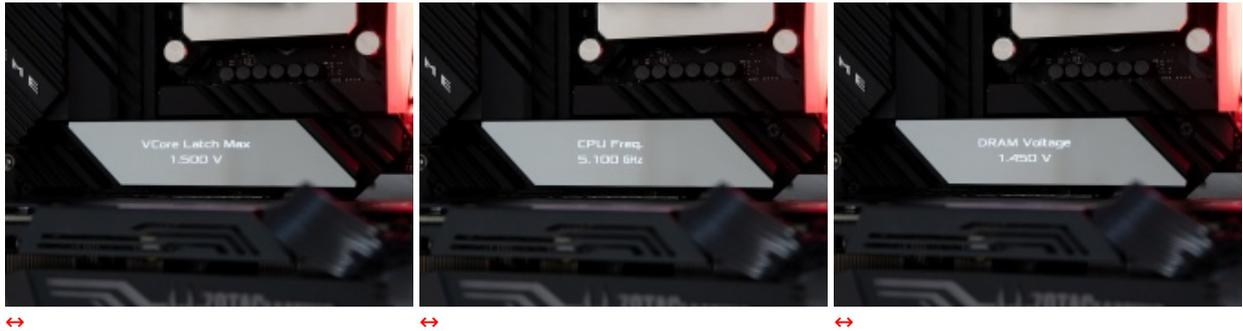
Il LiveDash OLED ci mostra una serie di informazioni relative allo stato della macchina come, ad esempio, le varie fasi del POST durante il boot, l'andamento di un eventuale aggiornamento del BIOS, la temperatura della CPU, le frequenze o le tensioni dei principali componenti.
