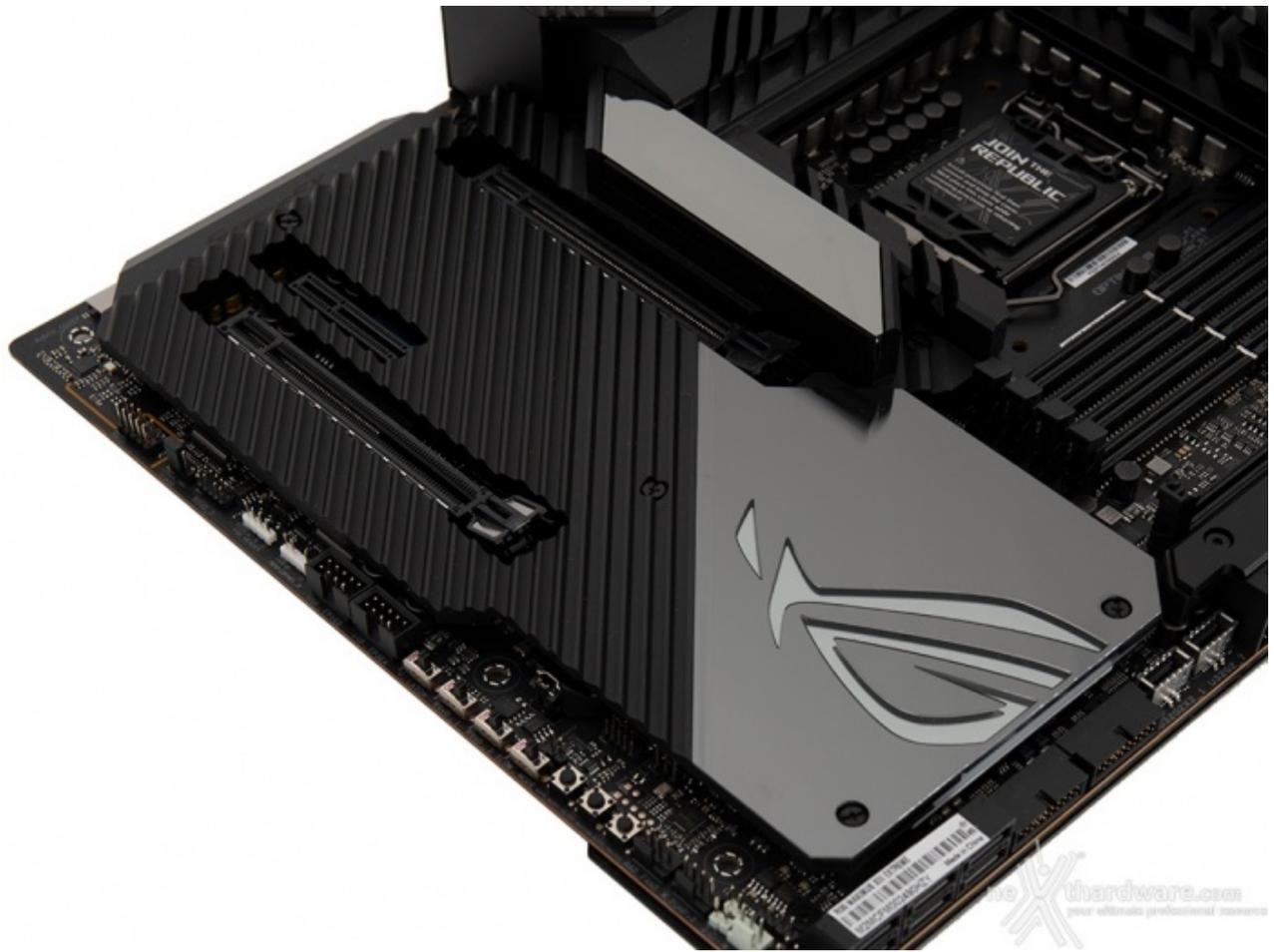
Infine, il quinto ed ultimo dissipatore, a basso profilo, è quello adibito al raffreddamento delle rimanenti unità M.2 e del chipset Z590.
