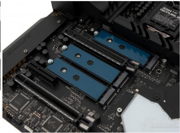
Grazie al supporto offerto dalle nuove CPU Rocket Lake, la ASUS ROG MAXIMUS XIII EXTREME è in grado di offrire tre ulteriori slot M.2 senza utilizzare alcun controller di terze parti.
