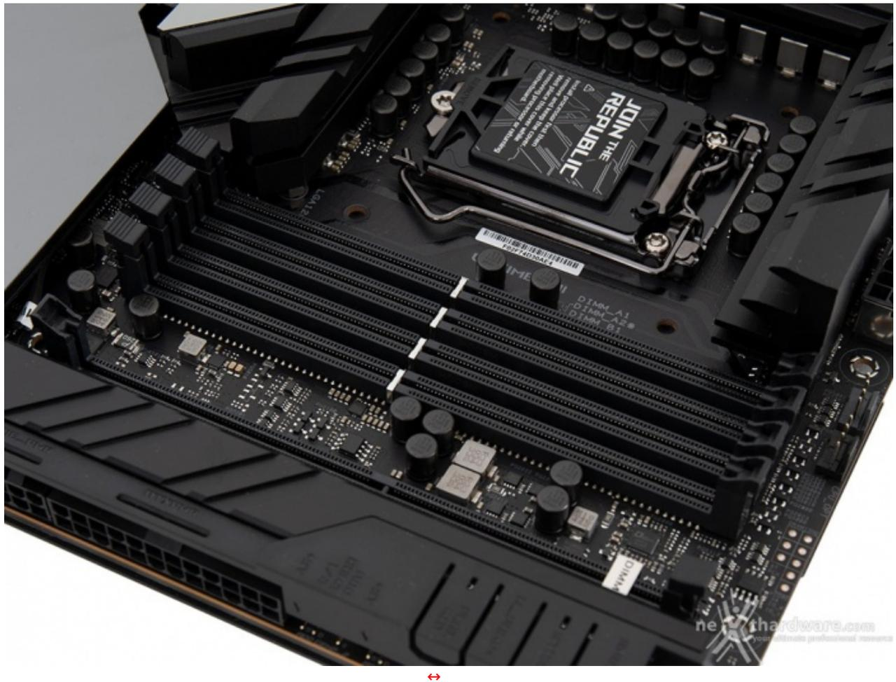
Il comparto dedicato alle memorie presenta quattro slot DIMM di colore nero in grado di ospitare 128GB di DDR4 con frequenze fino a 5333MHz (OC), ovvero sino a quattro moduli da 32GB l'uno (in modalità dual channel) dotati di profili Intel XMP 2.0 per la configurazione automatica dei relativi parametri di funzionamento.
