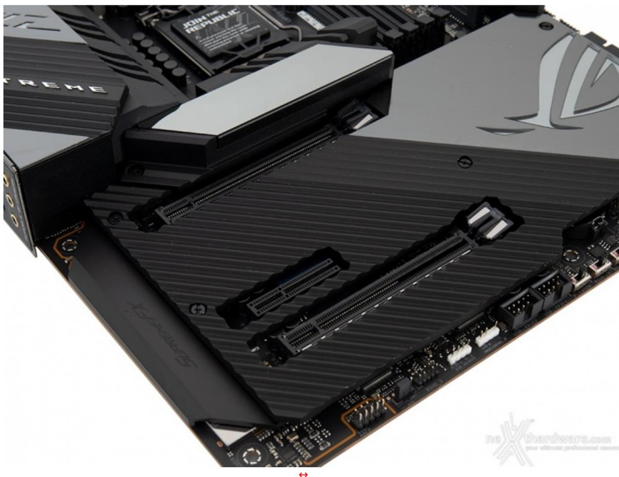
L'immagine in alto ci mostra la dotazione di slot PCI Express comprendente un PCIe 3.0 x4 ed altri due PCIe 3.0 x16 funzionanti, rispettivamente, in modalità x16 e x8.
