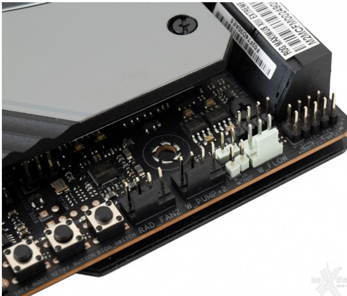
Posizionati accanto agli header del System Panel troviamo, ad esempio, una serie di header di colore bianco a cui andranno collegati i sensori relativi al flusso e alla temperatura del liquido in ingresso ed in uscita, nel caso in cui venga utilizzato un impianto di raffreddamento particolarmente avanzato.
