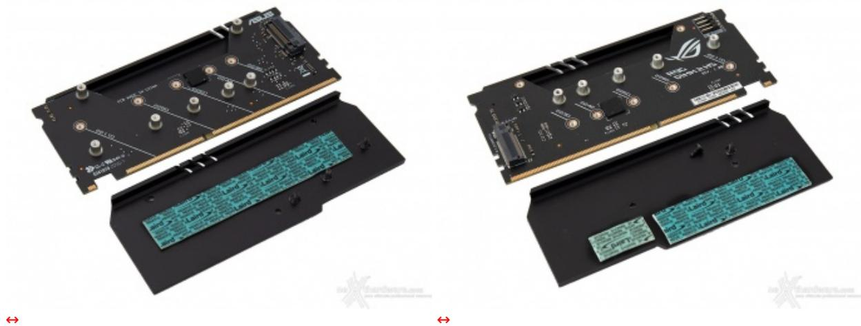
Nella dotazione accessoria della MAXIMUS XIII EXTREME troviamo il DIMM.2 Adapter, progettato per alloggiare due SSD M.2 (con lunghezza da 42 a 110 mm) il cui socket, come visibile nell'immagine sottostante, si trova accanto agli slot DIMM DDR4.
