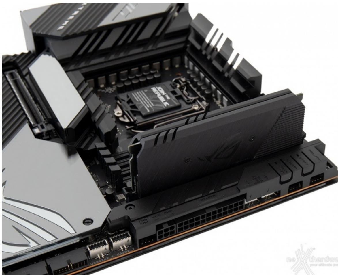
Il DIMM.2 Adapter è dotato di un elegante dissipatore in alluminio nero con finitura satinata, che va ad interfacciarsi con i drive tramite efficienti pad termici di produzione Laird.
