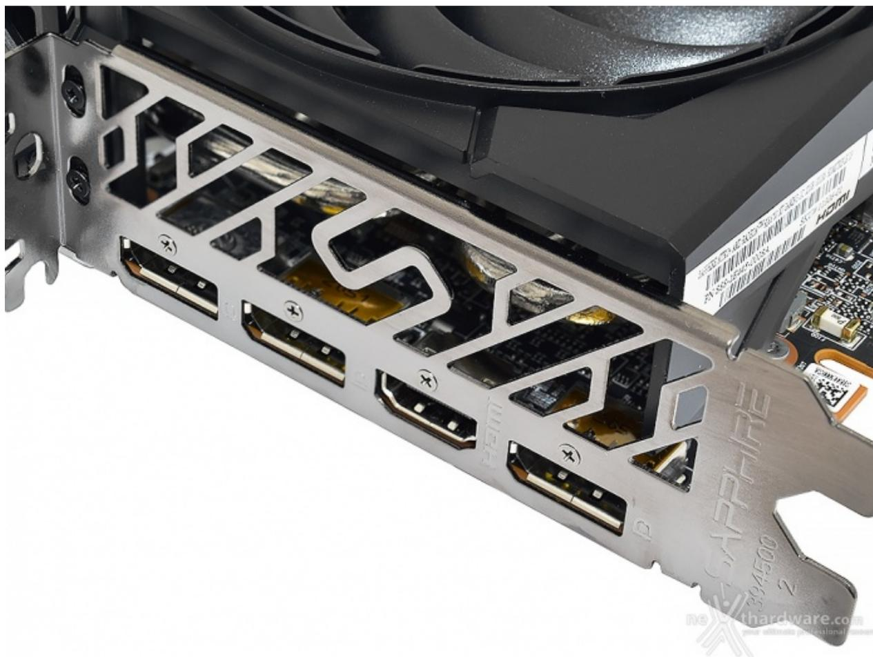
Il comparto delle connessioni è del tutto identico a quello del modello reference di AMD e consta di tre uscite DisplayPort 1.4 e una HDMI 2.1, per un totale di quattro porte.
