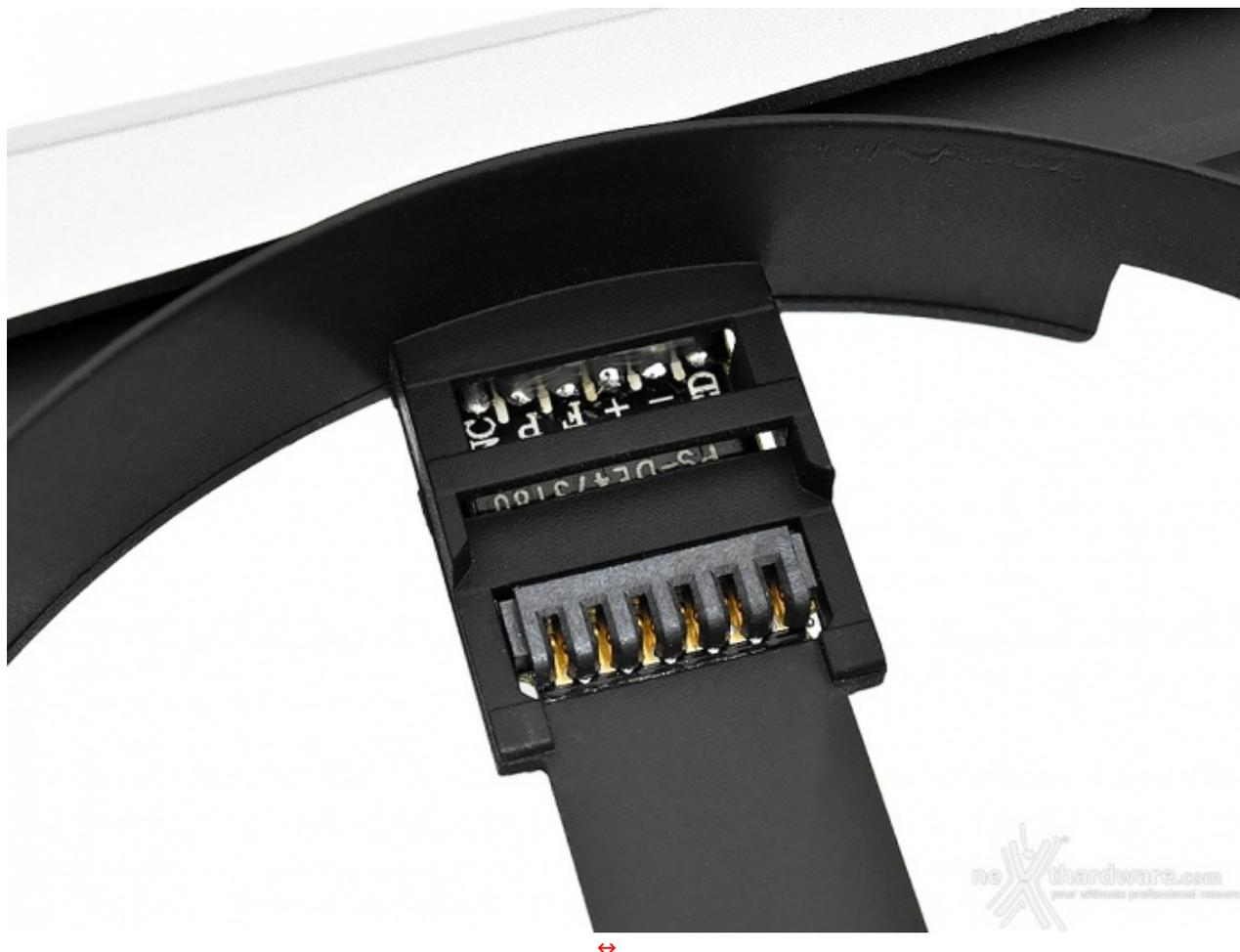
Analogamente a quanto visto sulle schede video della serie 400/500 (GCN 4.0) e 5000 (RDNA 1) prodotte da SAPHIRE, anche sulla NITRO+ Radeon RX 6700 XT le ventole utilizzano un metodo di collegamento, chiamato Quick Connect, che permette di sostituire, nel caso fosse necessario, le unità senza dover smontare la scheda.
