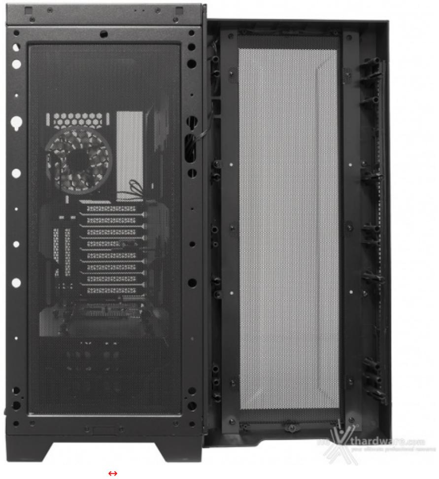
Fatto ciò, si avrà accesso ad un filtro antipolvere dotato di calamita, che rappresenta una ulteriore protezione rispetto al pannello in mesh.
