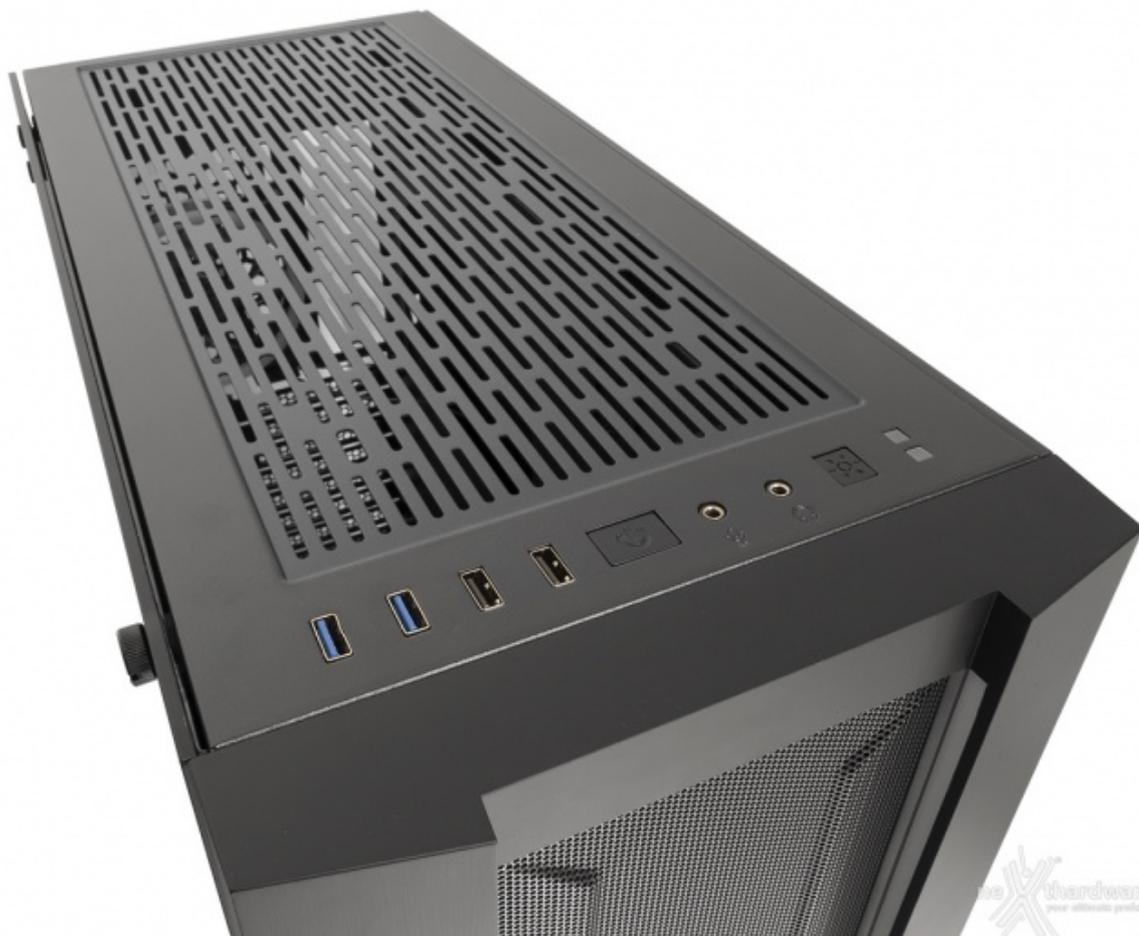
Il filtro superiore è posto a protezione di una seconda predisposizione per ventole (tre da 120mm o due da 140mm), anche in questo caso non presenti.
