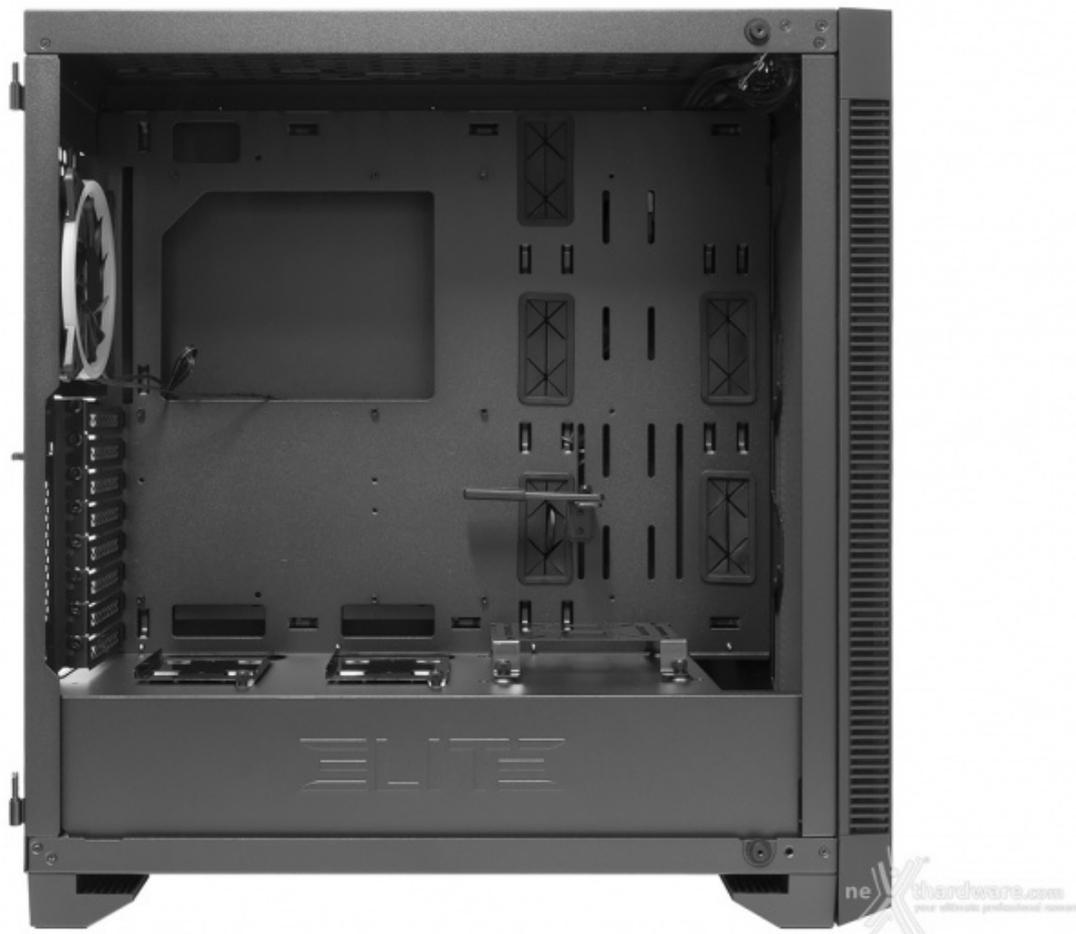
Ciò è dovuto principalmente all'assenza della copertura per cavi, il che rende più facile il cablaggio e permette, sin da subito, l'utilizzo di schede madri in formato E-ATX, SSI-EEC e SSI-CEB.
