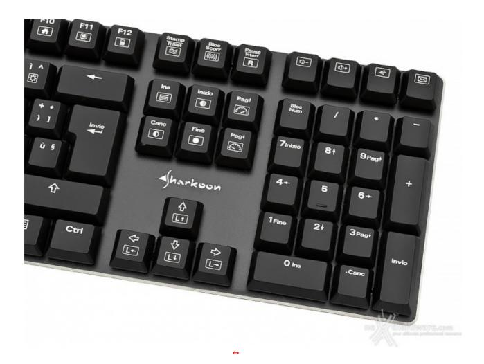
Per ridurre al minimo le dimensioni, la parte destra della tastiera, a differenza delle soluzioni classiche, non prevede i LED di stato, incorporati direttamente nei tasti di riferimento, i quali si illumineranno se attivi.
