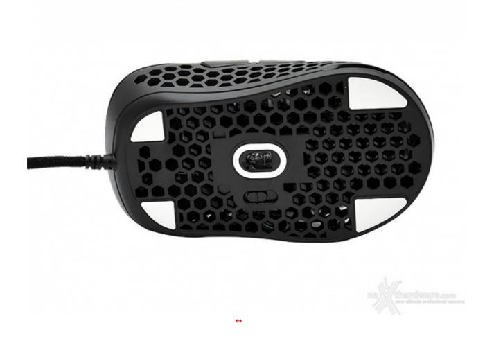
Passiamo ora al cuore del nuovo arrivato in casa Sharkoon, vale a dire il sensore ottico Pixart PMW3389, già visto su numerosi altri modelli e ampiamente collaudato, in grado di fornire una risoluzione massima di 16.000 DPI regolabile a step di un'unità tramite l'apposito software.
