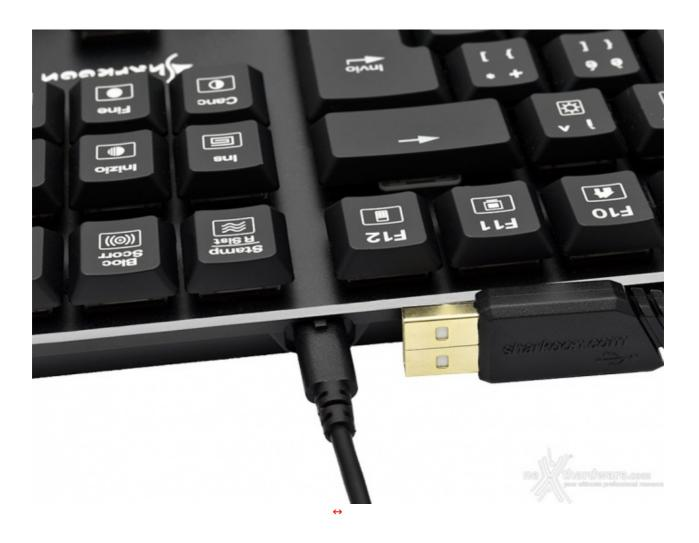
Il collegamento al computer è affidato ad un cavo in gomma USB/Micro-USB removibile, quindi facilmente sostituibile in base alle esigenze.
