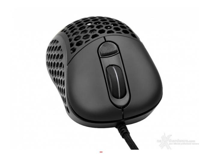
La struttura principale del mouse è interamente realizzata in robusta plastica ed è omogenea, non presentando, infatti, alcuna superficie differentemente testurizzata o ruvida.
