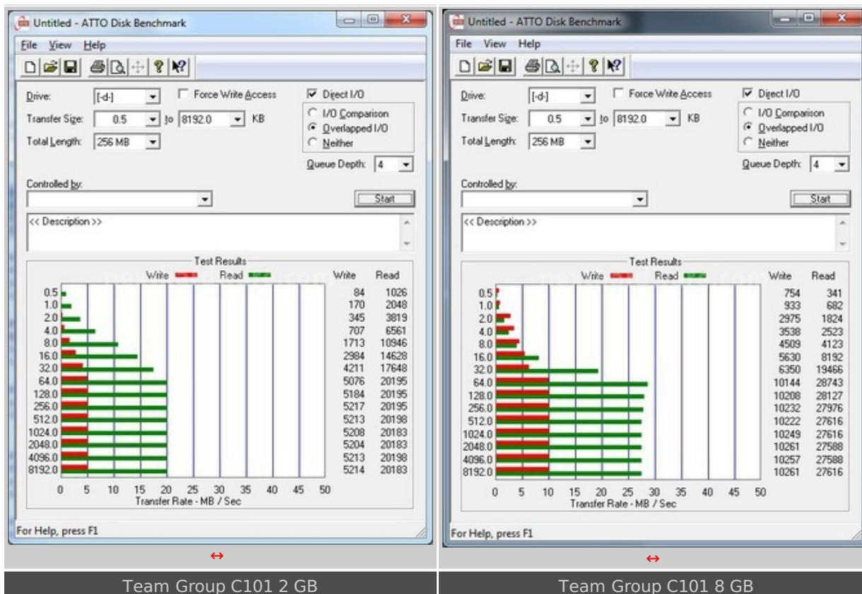
A differenza di quanto riportato da Team Group nelle specifiche tecniche, le performance fatte registrare con ATTO, superano quelle dichiarate, con circa 20 MB/Sec in lettura e 5 MB/Sec in scrittura per la versione da 2 GB, e oltre 27 MB/sec in lettura e 10 MB/Sec in scrittura per il modello da 8 GB
