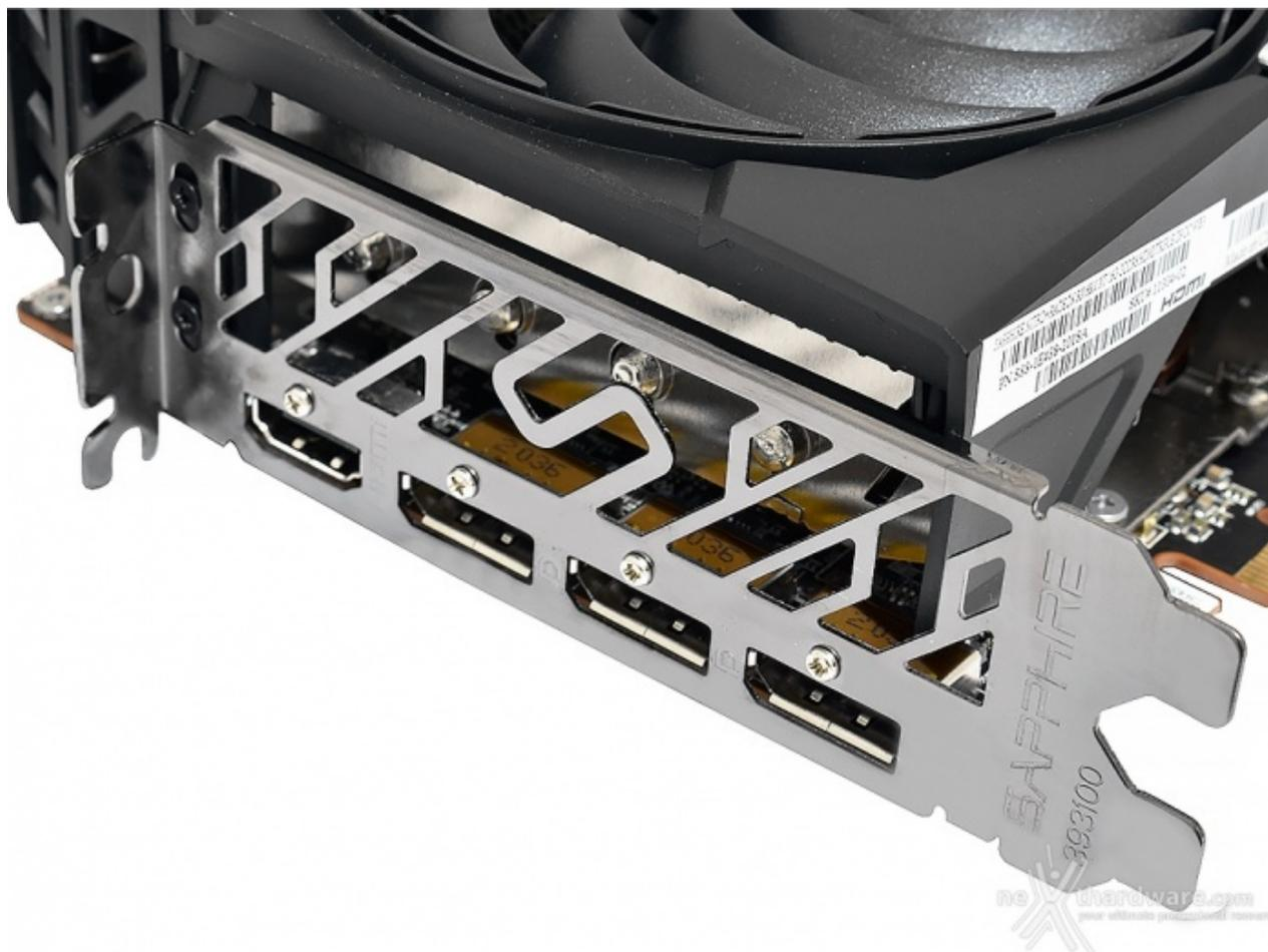
Il comparto delle connessioni differisce leggermente da quello del modello reference di AMD: al posto di una porta USB-C vi è un ulteriore DisplayPort, per un totale di quattro porte, nello specifico una HDMI 2.1 e tre DisplayPort 1.4.
