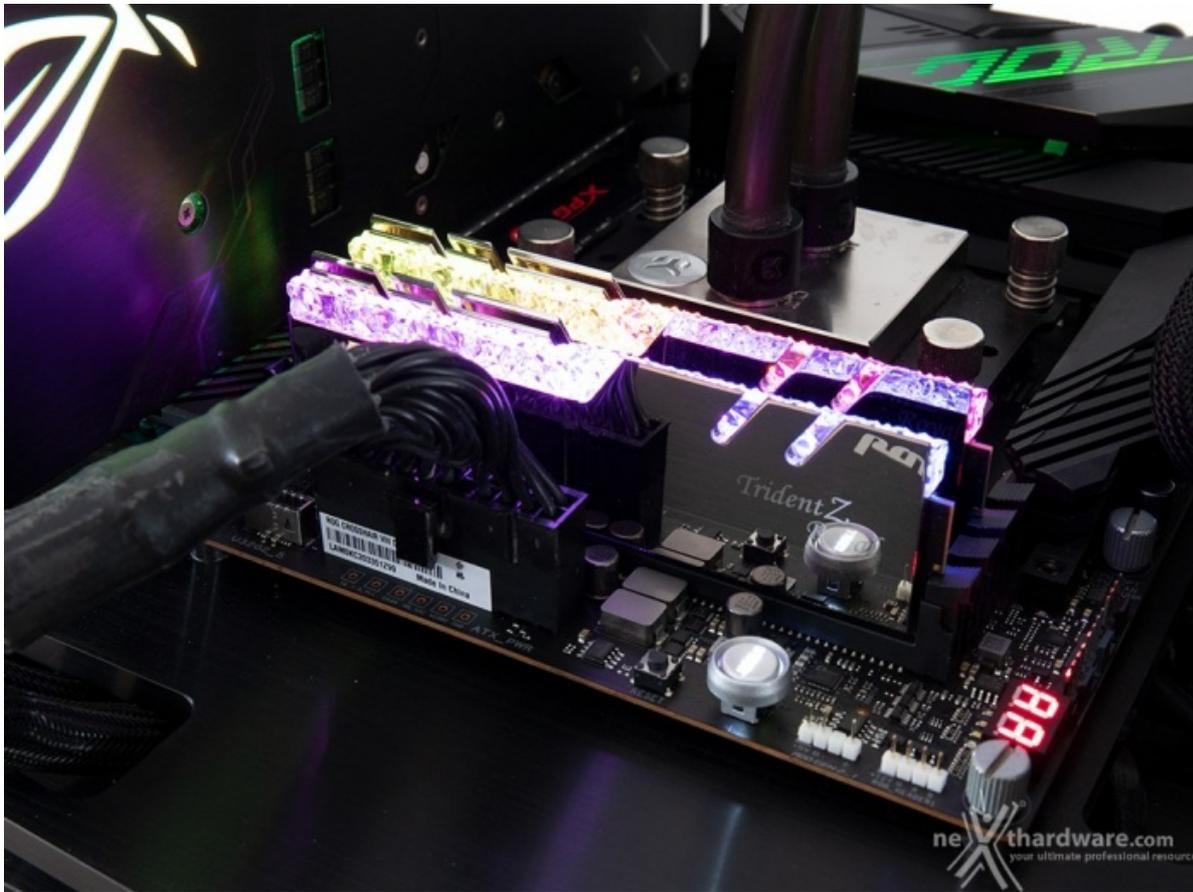
Consapevoli del fatto che la configurazione a quattro moduli può risultare limitante ai fini del raggiungimento del limite fisico degli ICs utilizzati, abbiamo voluto effettuare qualche prova con due soli moduli senza forzare il funzionamento dell'Infinity Fabric in modalità sincrona.
