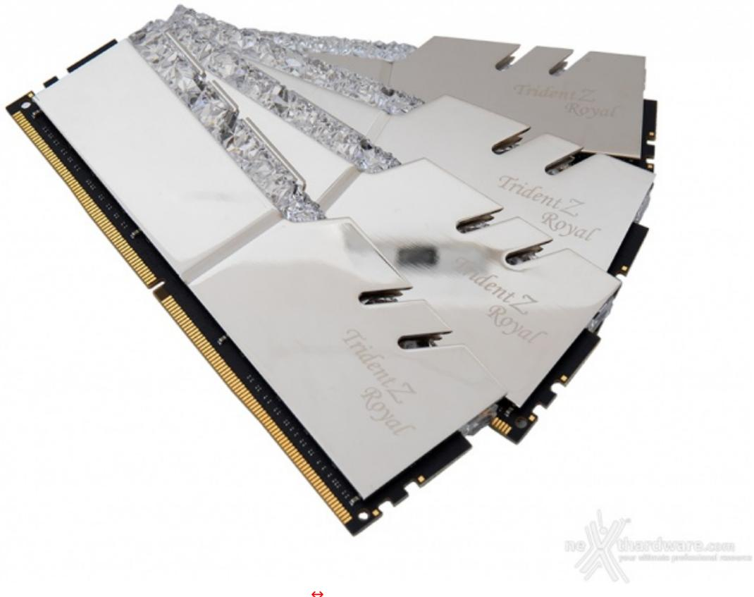
Riguardo la parte interna del modulo, da quel poco che si riesce ad intravedere senza disassemblarlo, possiamo affermare che i sedici chip di memoria da 1GB ognuno (per un totale di 16GB) sono equamente distribuiti su entrambe le facciate del PCB.
