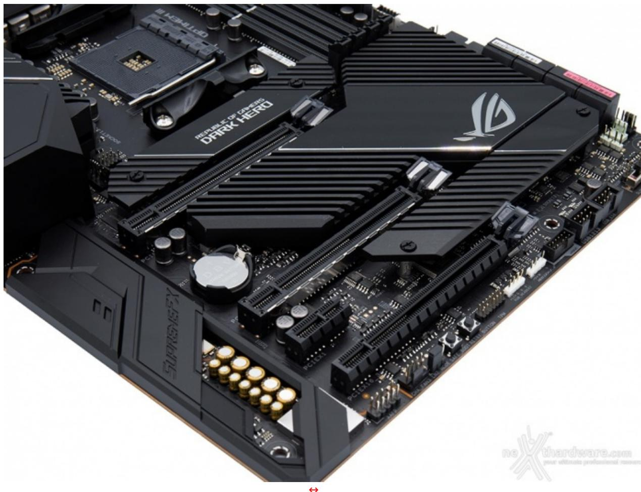
Nella foto in alto possiamo osservare la dotazione di slot PCI-E, di cui due x16 Gen4 pilotati dalla CPU, un x16 Gen4 ed un x1 Gen4 gestiti invece dal Fusion Controller HUB (FCH).
