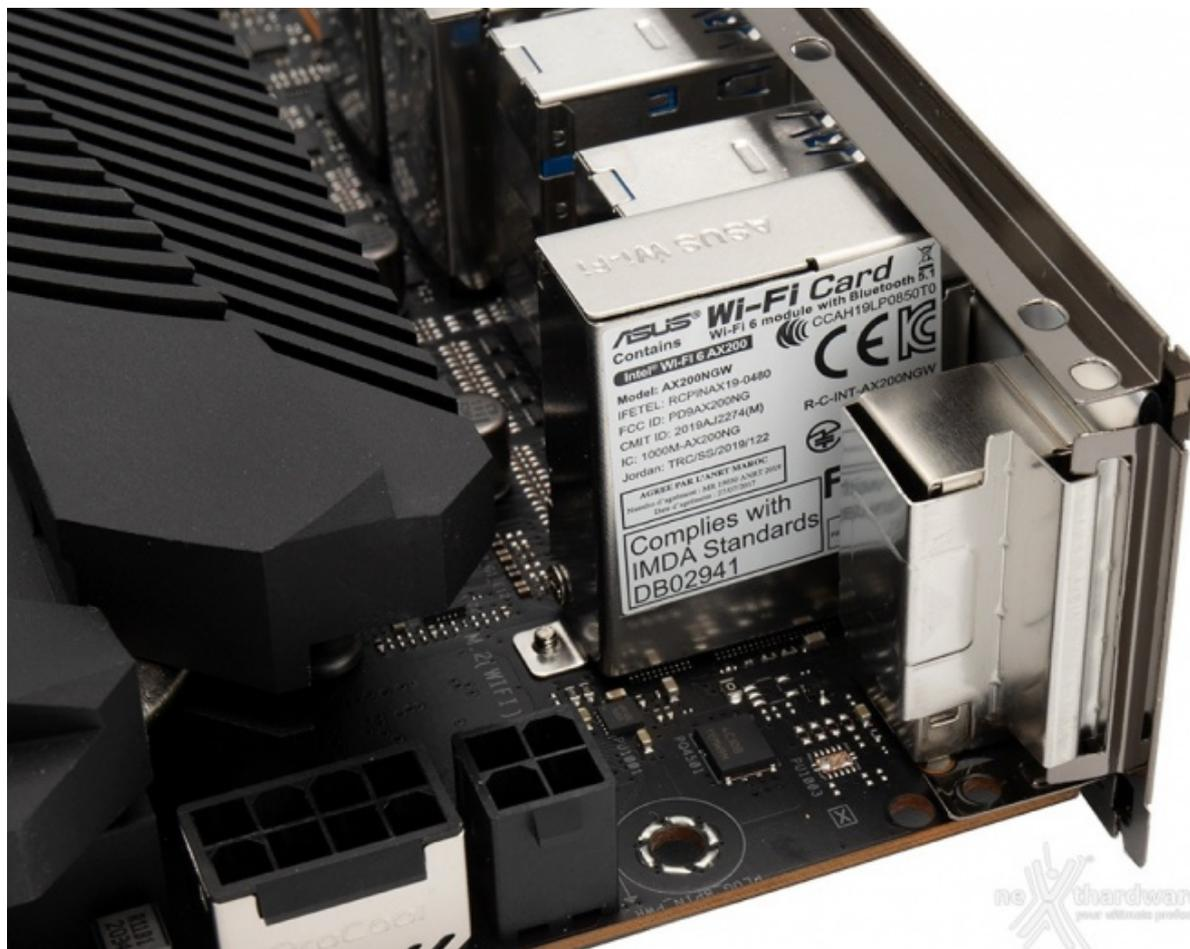
Il modulo Wi-Fi 2T2R è pilotato da un controller Intel WiFi 6 802.11ax con supporto MU-MIMO e consente connessioni dual band (2.4 e 5GHz) con velocità sino a 2400 Mbps utilizzando i canali a 160MHz.
