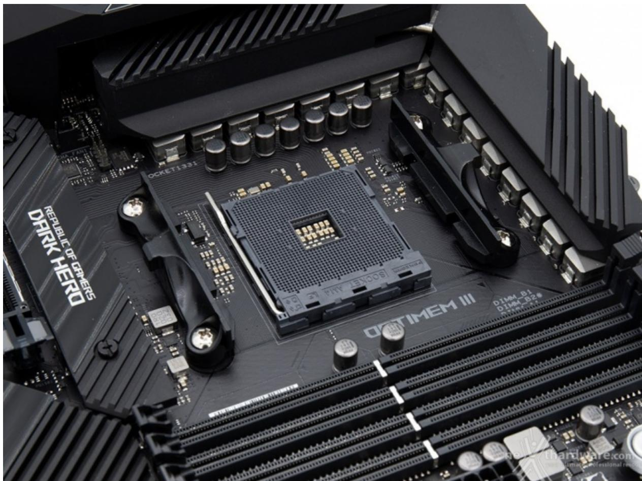
La ROG Crosshair VIII Dark Hero utilizza un socket AM4 in grado di supportare i nuovi processori Ryzen 5000, le APU con architettura Zen 2 e grafica VEGA integrata, mantenendo la compatibilità con Pinnacle Ridge, Raven Ridge, Summit Ridge e Bristol Ridge.
