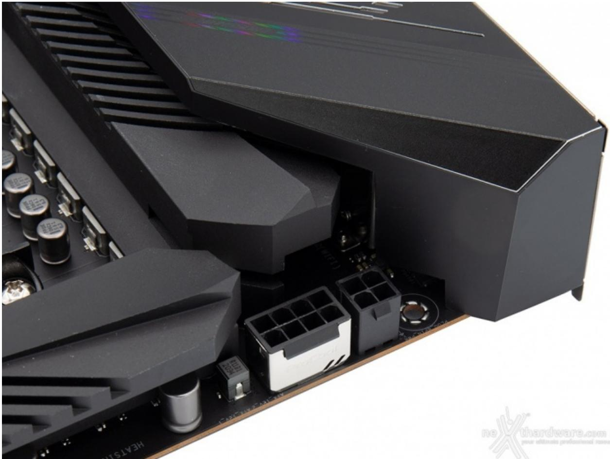
La presenza di un doppio connettore EPS 8+4 pin garantisce, poi, che la sezione di alimentazione riceva tutta la corrente necessaria, in particolar modo nelle condizioni di carico più gravose.
