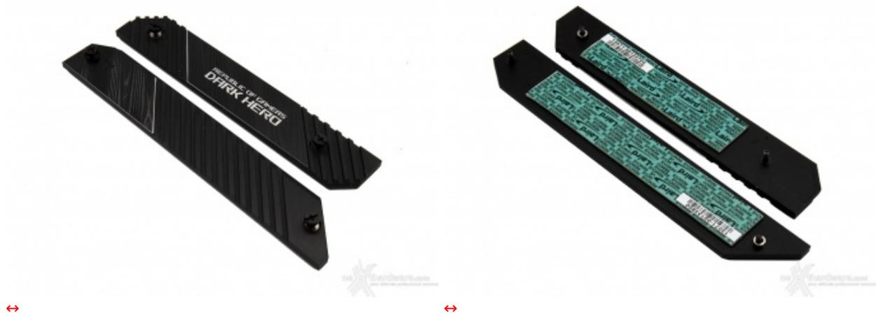
Entrambi gli slot beneficiano della presenza di un dissipatore passivo in alluminio che va ad interfacciarsi con i drive sottostanti tramite un pad termico ad alta efficienza di produzione Laird.
