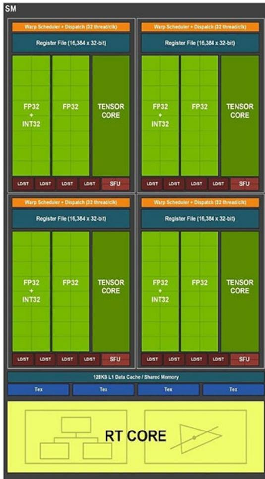
Simile anche la struttura di ogni SM, sempre composto da **quattro scheduler** questa volta con **32 FP32 CUDA Cores**, di cui 16 in grado di effettuare parallelamente operazioni INT32 e FP32.
