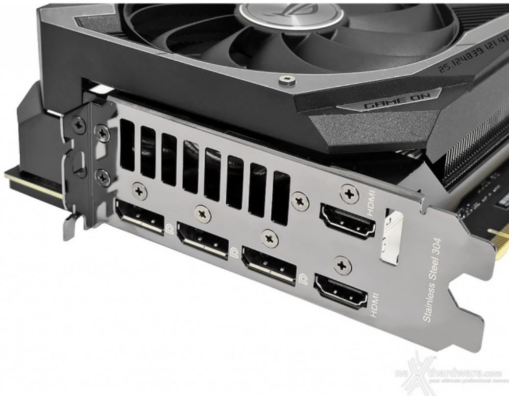
Il comparto delle connessioni è leggermente più fornito rispetto a quello del modello Founders Edition integrando, difatti, una HDMI 2.1 in più, per un totale di cinque porte: tre DisplayPort 1.4 e due HDMI 2.1.
