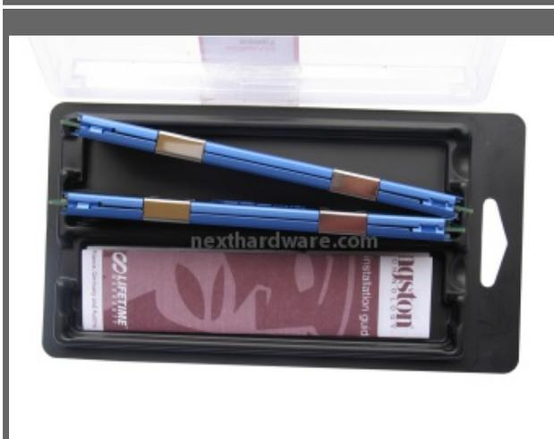
Una vista dall'alto dei due moduli che evidenzia il sistema di chiusura ad incastro dei due pezzi che costituiscono il dissipatore (uno per ogni lato) tenuti fermi da due clip metalliche. All'interno della confezione è presente il certificato di garanzia.
