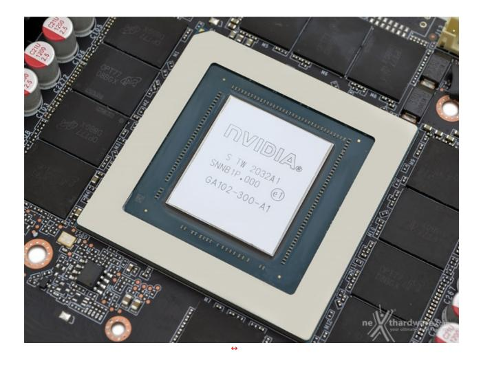
Al centro del PCB troviamo il processore grafico GA102-300-A1, realizzato per l'occasione da Samsung tramite processo produttivo a 8nm FinFET e dotato di ben 28 miliardi di transistor su una superficie di 628mm↔².
