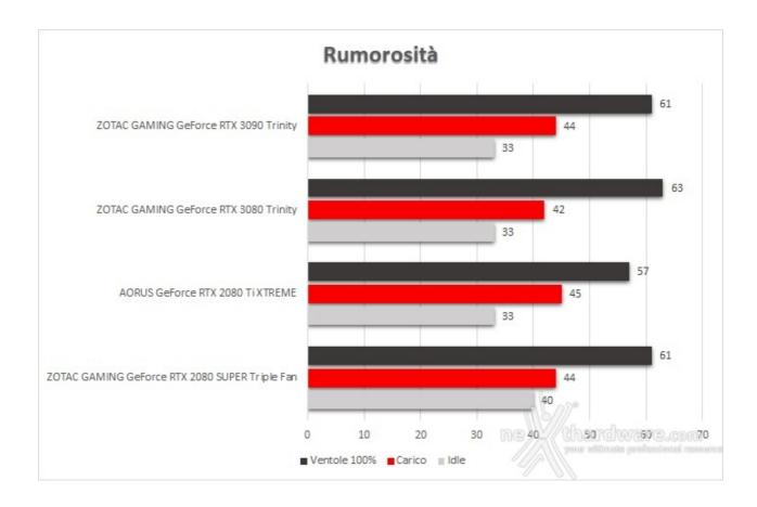
La RTX 3090 Trinity, grazie alla modalità Freeze Fan Stop che mantiene le ventole ferme a temperature inferiori ai  $55 \leftrightarrow ^{\circ}$ C, rimane completamente silenziosa ed il fonometro rileva il solo rumore ambientale.
