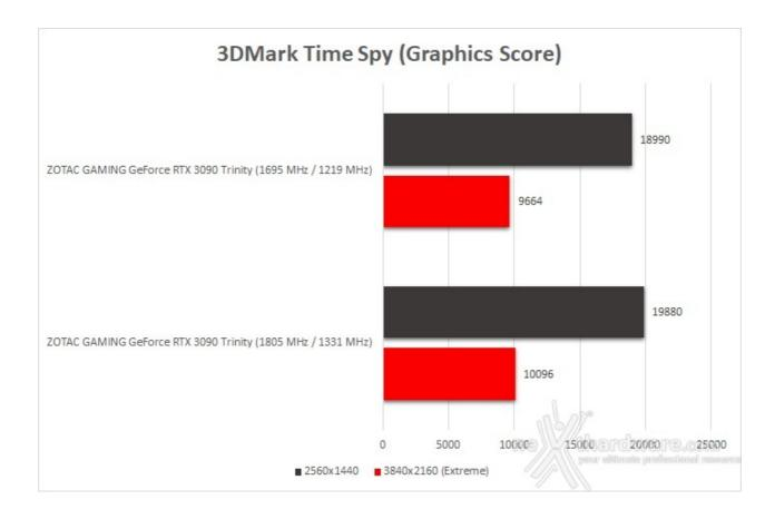
Anche in Time Spy il guadagno restituito dall'overclock è rilevante, con un punteggio superiore di 890 punti in QHD (+4,4%) e 432 in modalità Extreme (+4,2%).
