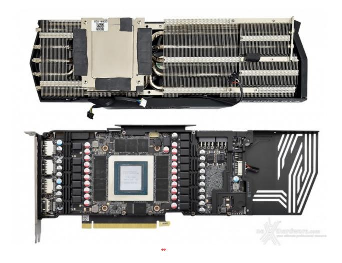
Per accedere al PCB della nuova ZOTAC GeForce RTX 3090 Trinity bisognerà , innanzitutto, rimuovere il massiccio corpo dissipante fissato alla struttura tramite sei viti, quattro in corrispondenza della GPU e altrettante nella zona terminale.
