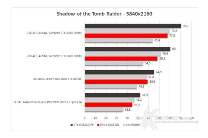
L'aumento della risoluzione fino al 4K permette alle schede di mostrare tutto il potenziale a disposizione, appianando notevolmente le differenze: la perdita di FPS conseguente all'attivazione del Ray Tracing, ma con DLSS 2.0 attivo, è mediamente del 15,4%
