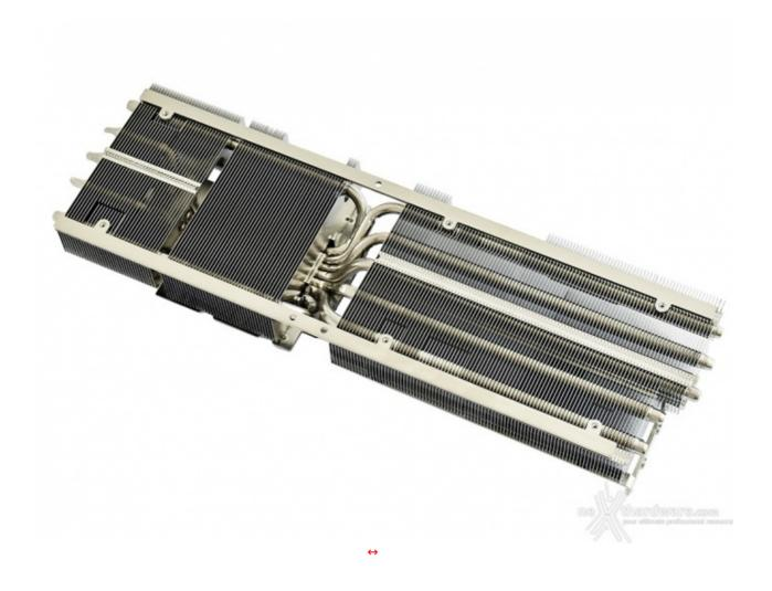
Il sistema di raffreddamento è lo ZOTAC IceStorm 2.0, utilizzato, con alcune lievi differenze strutturali, anche per la serie 2000, che consta oltre al tris di ventole sopracitate, di un robusto dissipatore costituito da un numero considerevole di alette in alluminio particolarmente fitte, attraversate da sette heatpipes in rame con uno spessore di ben 8mm.
