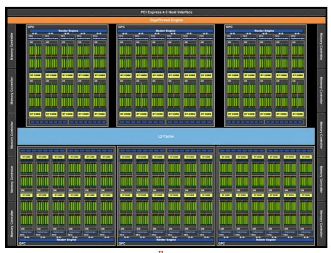
In alto possiamo osservare il diagramma a blocchi della GPU GA102-200 che equipaggia la RTX 3080.
