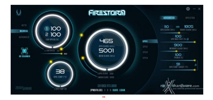
L'overclock massimo raggiunto sulla ZOTAC GeForce RTX 3090 Trinity è stato di +110MHz sulla GPU e di +900MHz sulla frequenza complessiva delle GDDR6X.
