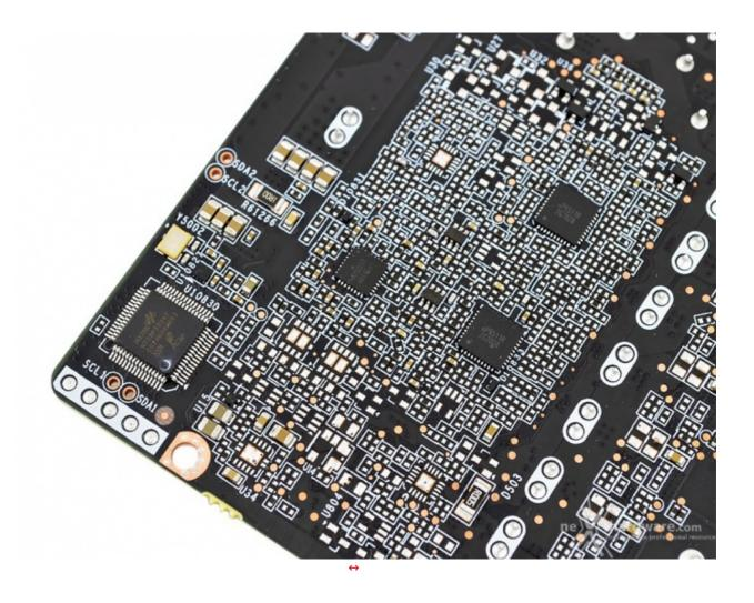
Come anticipato, la zona posteriore del PCB ospita due dei tre controller per le fasi uP9511R ed il circuito per la gestione dell'illuminazione ARGB (in foto in basso a sinistra) pilotato da un processore ARM Cortex M0+ a 32bit, nello specifico un Holtek HT32F52342, lo stesso montato da ZOTAC sulla gamma AMP serie 1000 e 2000.
