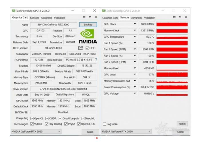
La schermata di GPU-Z mostra i parametri massimi impostati, ovvero 1805MHz di boost clock per il core e 1331MHz effettivi per le memorie GDDR6X, il tutto in completa stabilità .
