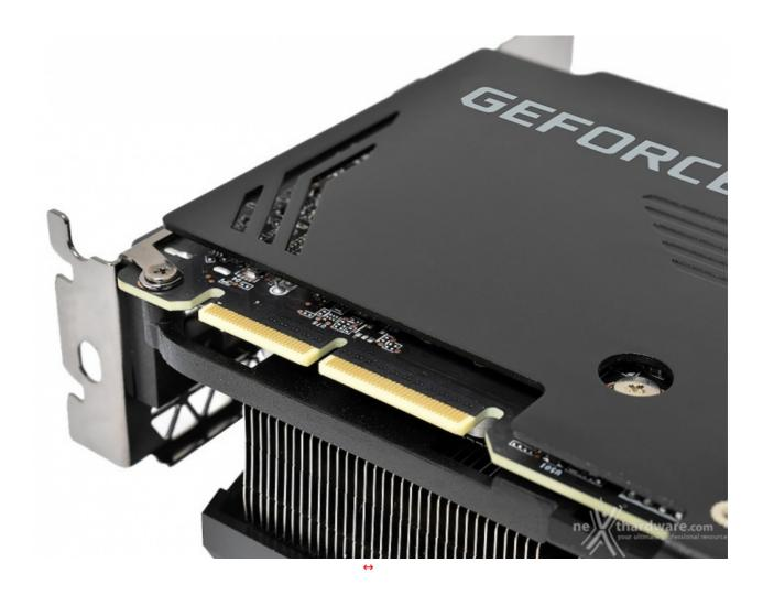
La GeForce RTX 3090 è l'unica scheda di nuova generazione con il supporto multi GPU e, chiaramente, anche nel caso della soluzione proposta da ZOTAC troviamo il relativo connettore sul lato sinistro della scheda.
