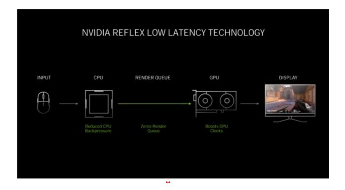
Grazie a Reflex, il driver NVIDIA opererà in maniera parallela con il motore di gioco così da **snellire** sensibilmente la pipeline di rendering e abbattere le latenze tra mouse e display.
