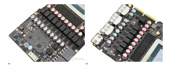
Le 18 fasi (15 per la GPU e 3 per la VRAM) sono pilotate da un tris di controller analogici multifase (fino a 8 fasi) <u>uP9511R (https://datasheetspdf.com/pdf-file/1347327/uPlSemiconductor/uP9511/1)</u> realizzati da uPl Semiconductor.
