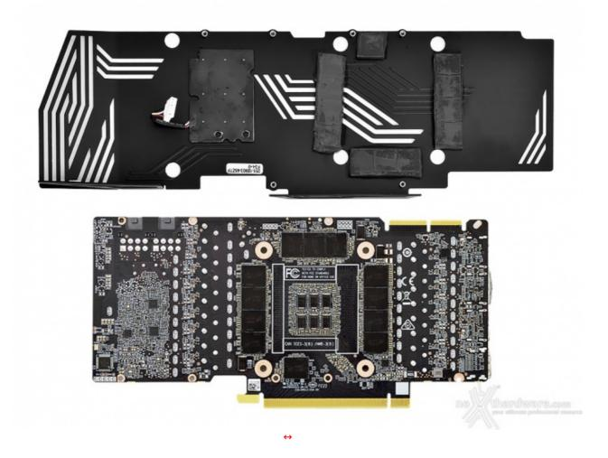
A questo punto sarà possibile rimuovere anche le ulteriori otto viti che serrano il backplate mettendo completamente a nudo il PCB, pronto per essere analizzato nel dettaglio.
