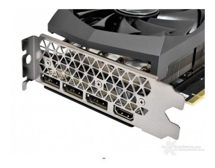
ZOTAC, infine, ha scelto di dotare la sua RTX 3090 Trinity dello stesso comparto connessioni del modello Founders Edition, esattamente con la medesima disposizione, ovvero tre DisplayPort 1.4 e una HDMI 2.1.
