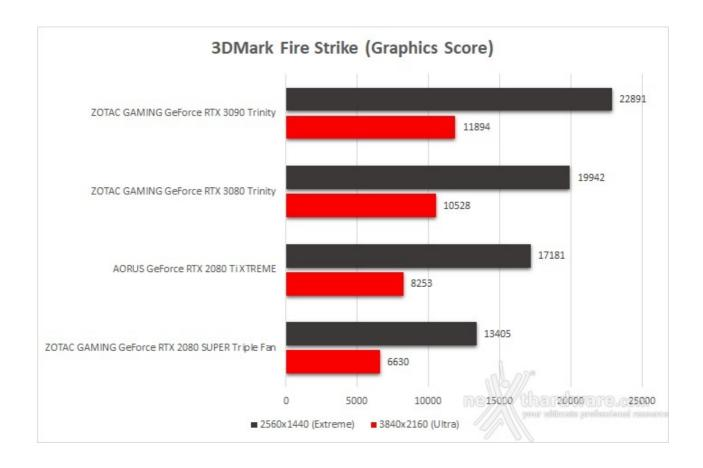
Nel benchmark di Fire Strike abbiamo un primo assaggio di tutta la potenza della RTX 3090 Trinity, che ottiene l'incredibile risultato di 22891 punti in QHD: il 14,7% superiore rispetto alla sorella minore ed il 33,2% alla top di gamma della generazione precedente.
