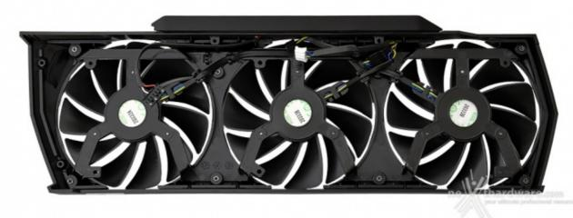
La cover superiore è vincolata al dissipatore tramite otto viti di piccolo taglio e incorpora le tre ventole da 90mm installate su questo modello.
