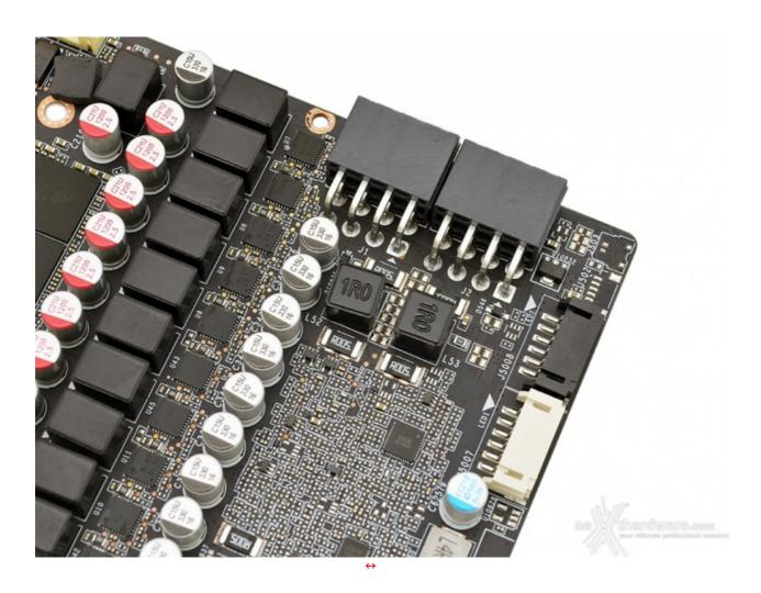
A differenza dei modelli Founders, che introducono il nuovo connettore PCI-E 12 pin progettato da NVIDIA, ZOTAC, così come gli altri parner AIB, ha dotato la serie Trinity degli usuali connettori PCI-E 8 pin, due nello specifico, in grado di fornire alla scheda fino a 375W di potenza complessivi (300W dei connettori più 75W dello slot PCI-E), più che sufficienti per assecondare la GPU anche in forte overclock.
