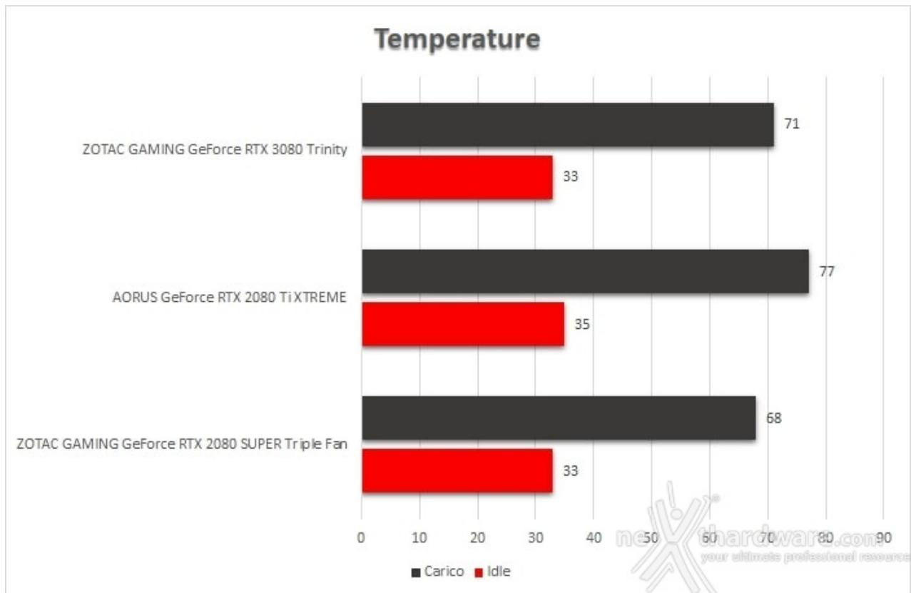
L'enorme dissipatore e le potenti ventole con le quali ZOTAC ha munito la propria RTX 3080 Trinity mostrano i muscoli durante la prova di rilevazione termica: sotto carico la scheda raggiunge appena i 71 ↔°C di picco, un ottimo risultato, soprattutto a fronte dei 77 ↔°C ottenuti dalla AORUS RTX 2080 Ti XTREME.
