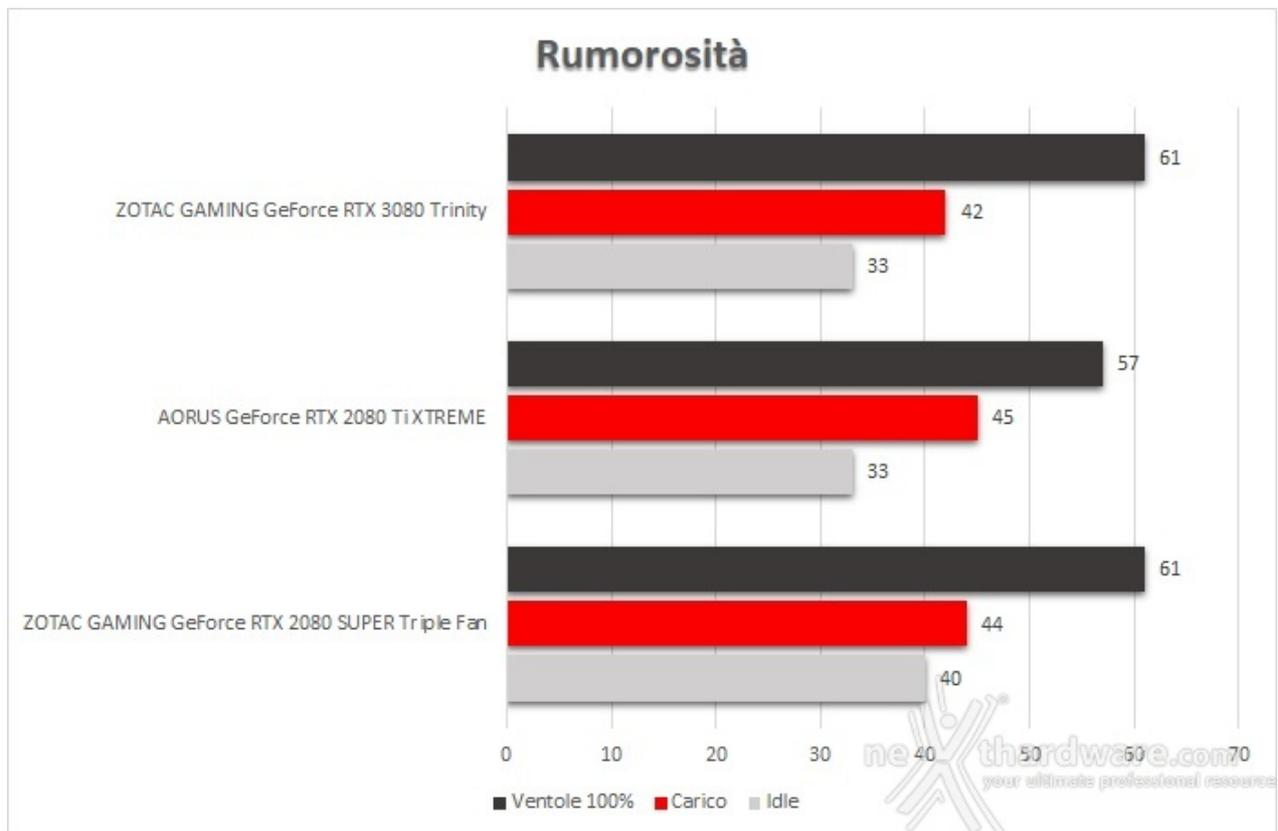
La RTX 3080 Trinity, forte della modalità Freeze Fan Stop che mantiene le ventole ferme a temperature inferiori ai 55 °C, rimane completamente silenziosa ed il fonometro rileva il solo rumore ambientale.
