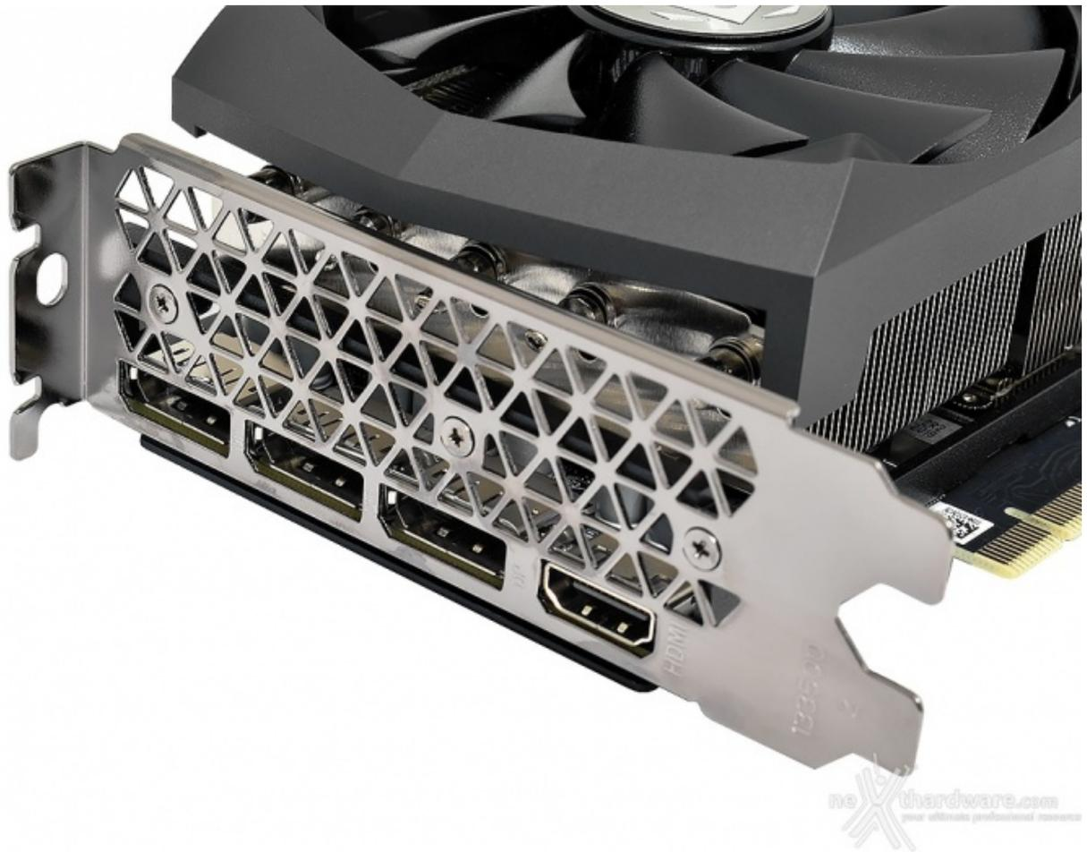
ZOTAC, infine, ha scelto di dotare la sua RTX 3080 Trinity dello stesso comparto connessioni del modello Founders Edition, esattamente con la medesima disposizione, ovvero tre DisplayPort 1.4 e una HDMI 2.1.
