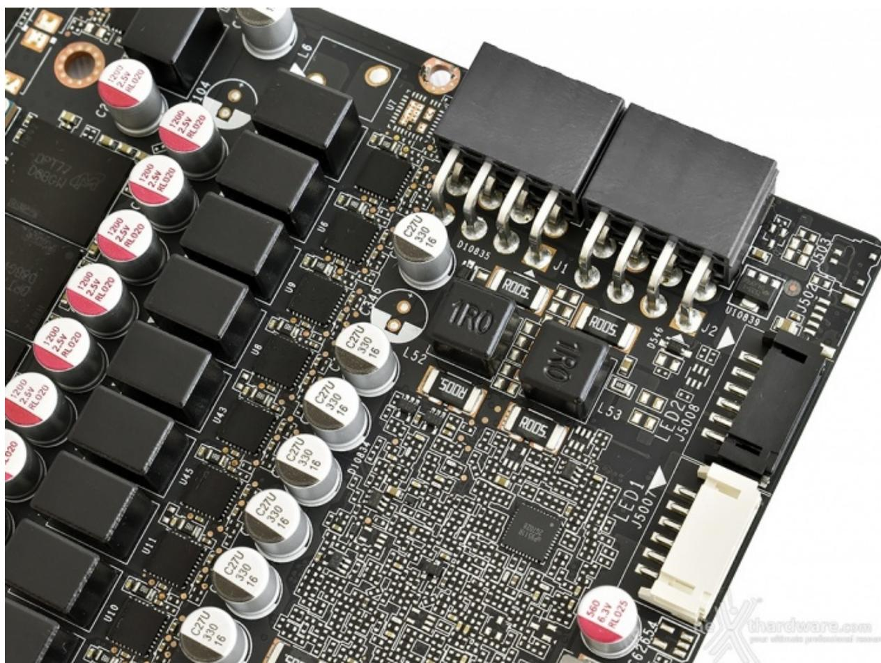
A differenza dei modelli Founders, che introducono il nuovo connettore PCI-E 12 pin progettato da NVIDIA, ZOTAC, con gran parte dei produttori di schede custom, ha deciso di dotare la serie Trinity degli usuali connettori PCI-E 8 pin, due nello specifico, in grado di fornire alla scheda fino a 375W di potenza complessivi (300W dei connettori più 75W dello slot PCI-E), più che sufficienti per assecondare la GPU anche in forte overlock.
