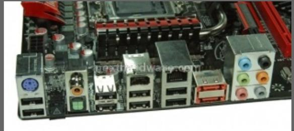
La Katana Inferno prevede un controller VIA VT6308S per il supporto allo standard IEEE 1394a, un Realtek ALC 888SD con supporto a 8 canali audio HD con Dolby Digital Live e DTS, un controller Realtek 8111DL Gigabit LAN.
