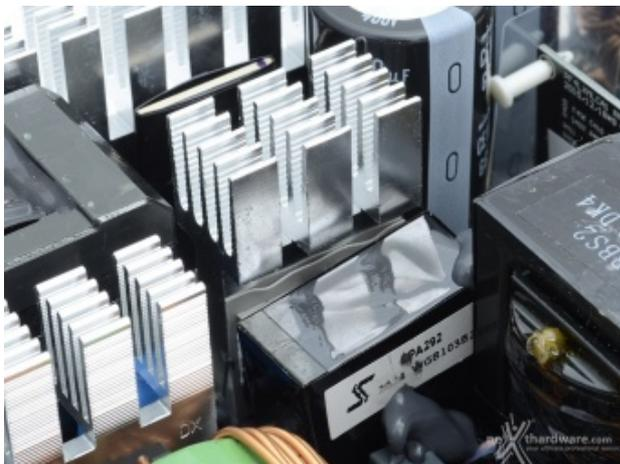
Particolare del dissipatore dedicato ai transistor di switching.
