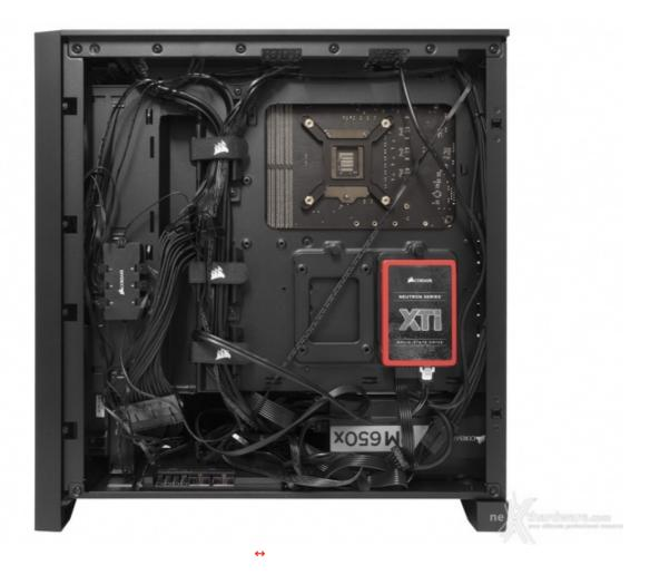
Avendo optato per un drive M.2 affiancato da un SSD, abbiamo rimosso il cestello inferiore andando a ricavare spazio per i cavi in eccesso e per il CORSAIR Commander Pro che, nella nostra configurazione, si occuperà di gestire ventole e sistema di illuminazione.
