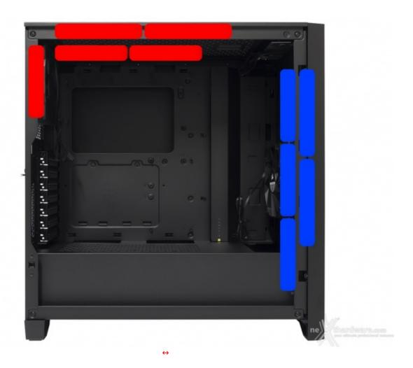
Un case del genere, tuttavia, non è pensato per chi vuole accontentarsi di due sole ventole, pertanto è possibile installare ulteriori tre unità da 120 o due da 140mm sul frontale più altre due da 120 o 140mm sul top.
