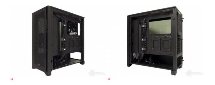
Sotto l'apertura situata in corrispondenza del socket per la CPU è possibile montare due drive da 2,5" su appositi supporti removibili.
