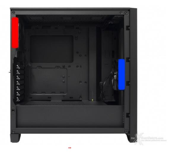
Di serie, il 4000D è commercializzato con due ventole preinstallate, nello specifico una frontale in immissione ed una nella parte posteriore deputata all'espulsione dell'aria calda.
