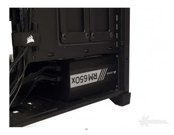
In seguito, una volta rimosso il pannello destro, abbiamo posizionato l'alimentatore RM650X all'interno del suo scomparto sistemando, in parte, i cavi d'alimentazione per CPU e scheda video.
