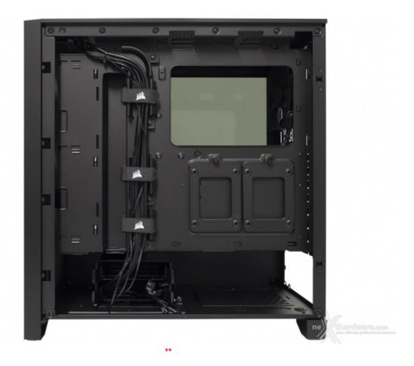
Rimuovendo il pannello destro possiamo analizzare il retro del piatto mainboard, anch'esso abbastanza razionale grazie, soprattutto, all'assenza di fori e alla presenza del sistema di gestione dei cavi denominato RapidRoute.
