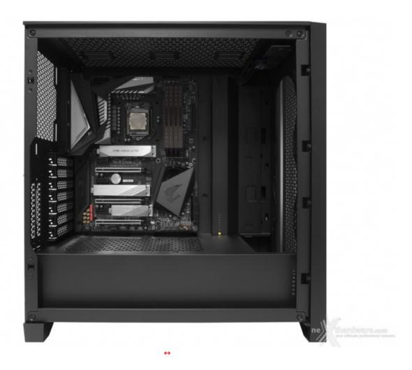
Il primo componente a trovar spazio all'interno dell'ampio vassoio è stata la scheda madre, completa di CPU, moduli RAM e drive M.2.
