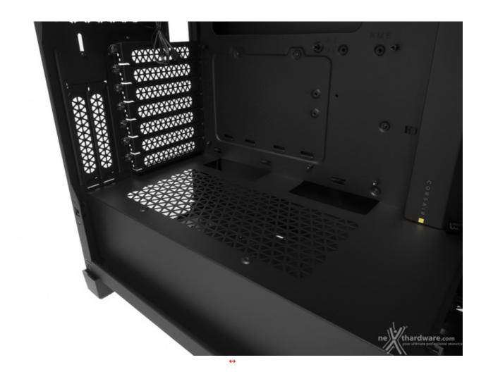
Il vano mainboard è diviso da quello adibito all'alimentatore da una cover in acciaio con griglia d'aerazione nella parte alta, che permette il fissaggio di due supporti per drive da 2,5".
