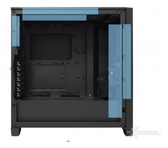
Tutte le predisposizioni possono essere utilizzate anche per il contenimento di radiatori facenti parte di sistemi di raffreddamento a liquido AiO o custom, nello specifico uno da 360 o 280mm frontalmente, uno da 120 sul retro e uno da 240 o 280mm sul top.
