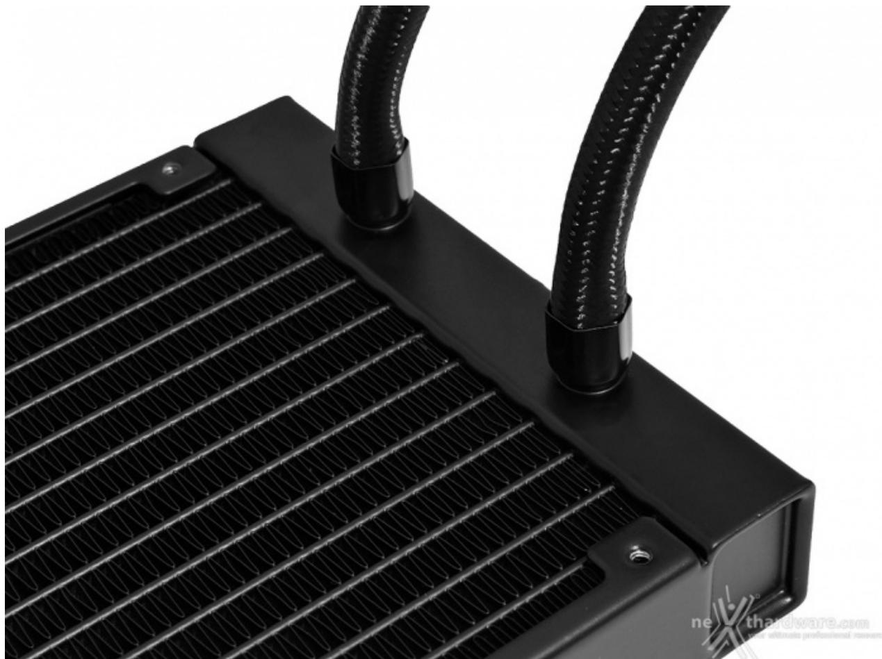
I tubi in dotazione al nuovo AiO di CORSAIR sono sufficientemente lunghi (380mm) e spessi (8-10mm), realizzati in gomma a bassa permeabilità e rivestiti in tessuto in modo da assicurarne un buon livello di flessibilità evitando eventuali strozzature e facilitarne l'installazione all'interno del case.
