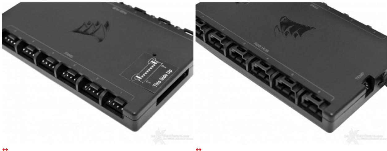
Il bundle è reso ancor più ricco dalla presenza del controller iCUE Commander CORE, che permette di collegare in tutta comodità fino a sei ventole PWM RGB, semplificando le operazioni di cablaggio e permettendo di risparmiare preziosi header sulla scheda madre.
