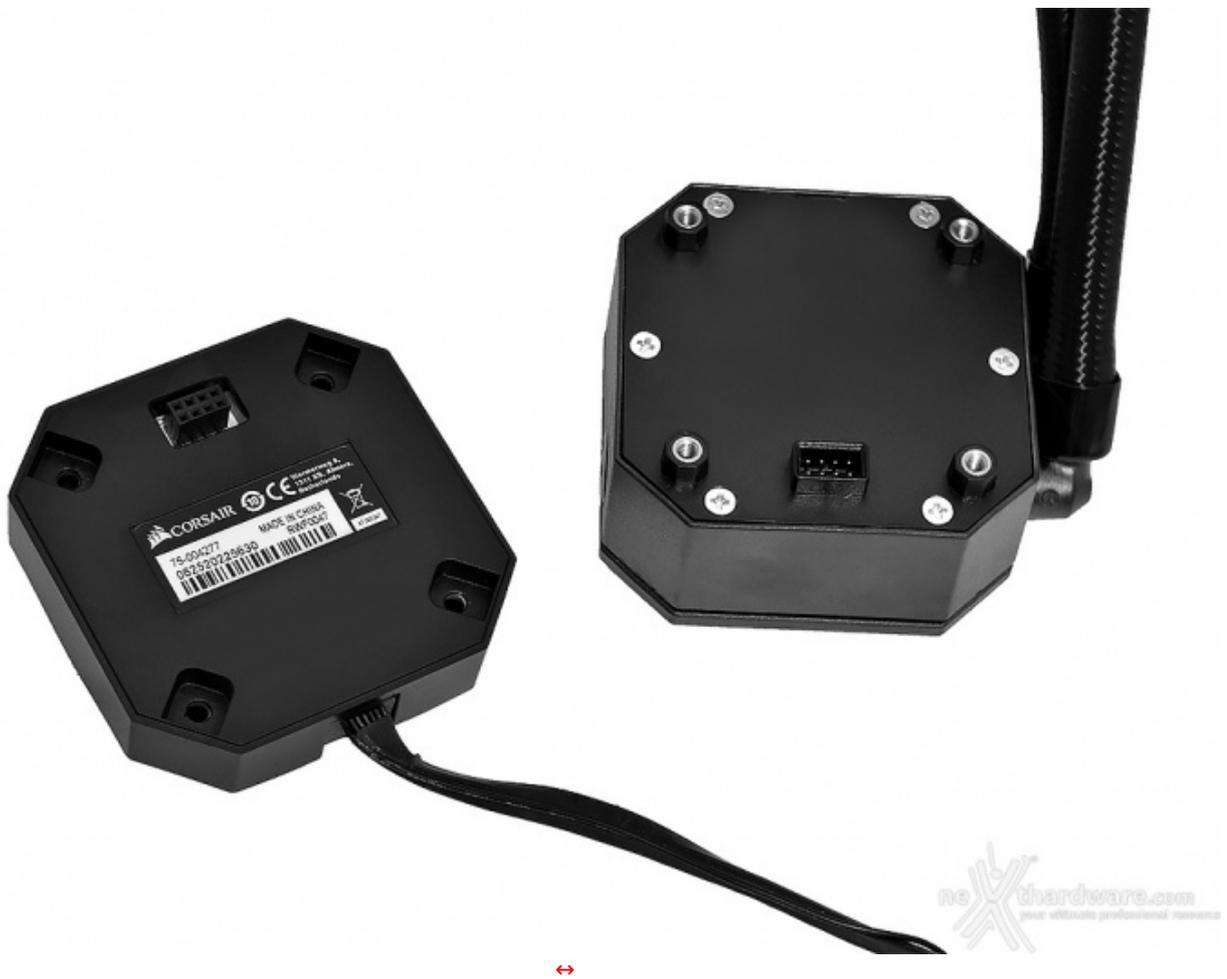
Rimuovendo le viti, il blocco principale può essere ulteriormente separato: è infatti possibile rimuovere in tutta sicurezza la zona dove sono installati i 33 LED RGB e la relativa cavetteria.
