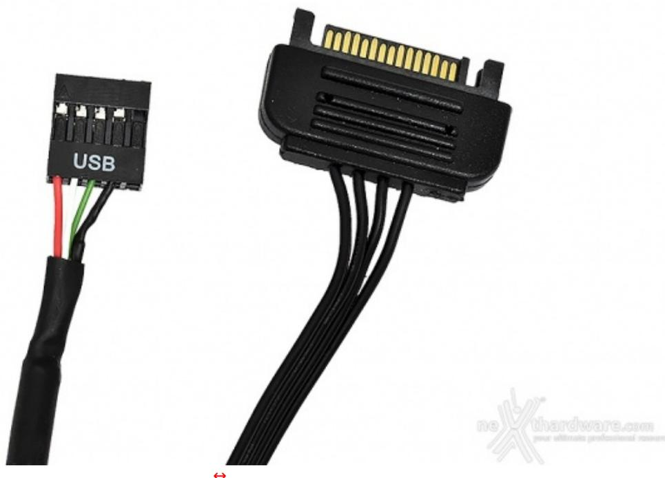
La cavetteria in uscita dal Commander CORE è composta unicamente da due connettori: un SATA POWER si occuperà di garantire i 12V necessari al corretto funzionamento di tutto il sistema ed un connettore USB 2.0 per interfacciarsi con il software di gestione iCUE.
