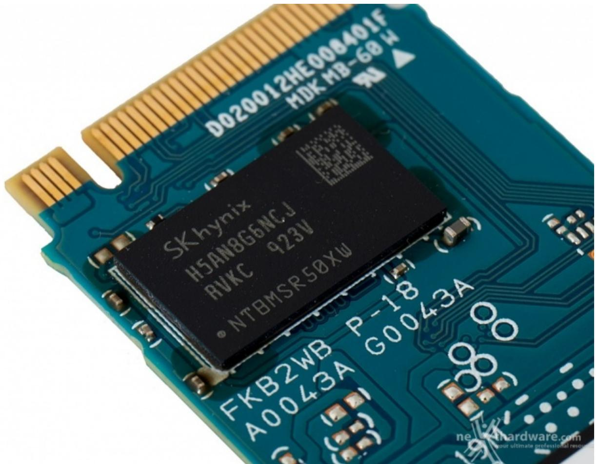
Da ultimo un close-up di uno dei due chip DRAM SK hynix 2666MHz da 1GB identificato dalla sigla **H5AN8G6NCJ** ed utilizzato come cache dei dati per velocizzare le operazioni del controller.
